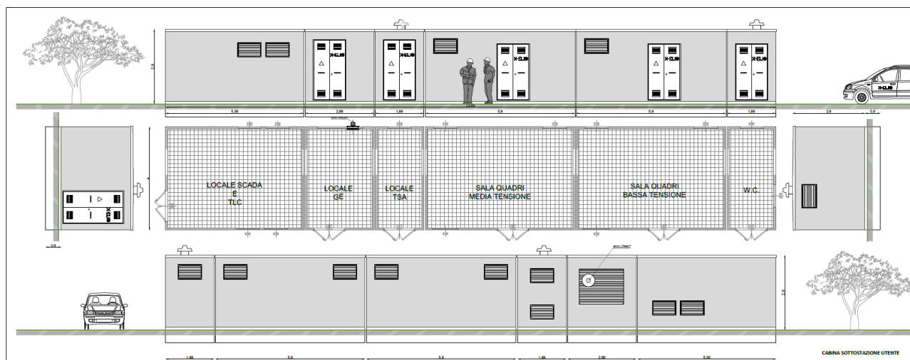
Edificio di consegna cavidotti in MT
