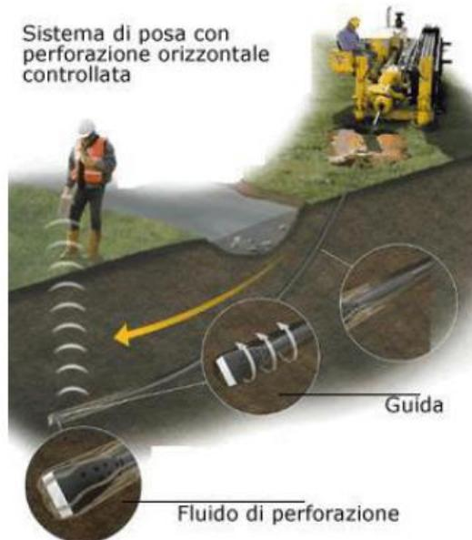
Sistema di trivellazione orizzontale controllata (T.O.C.)
