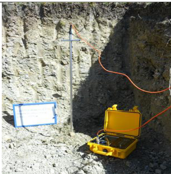
Fig.2 - Strumentazione per misura di conducibilità termica
