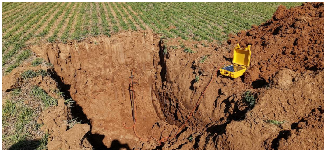
FOTO 6 – MISURA DI RESISTIVITÀ TERMICA
