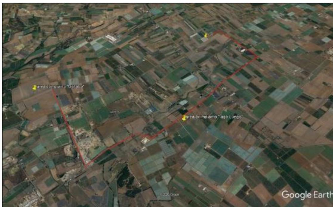
**FIGURA 6 – PERCORSO DEL CAVIDOTTO DO COLLEGAMENTO TRA LE AREE E LA SSE TERNA E SS UTENTE**
