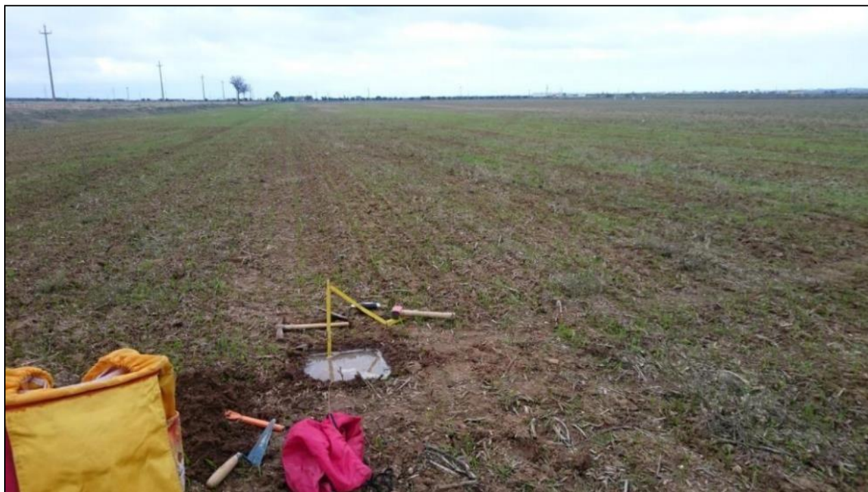
FIGURA 51 – PROVA DI PERMEABILITÀ A CARICO VARIABILE “GIRIFALCO”
