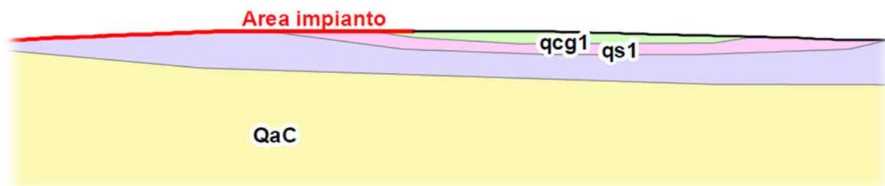
**Fig. 3. Stralcio di una sezione geologica in cui è possibile apprezzare la stratificazione sub-orizzontale delle formazioni presenti in loco.**
