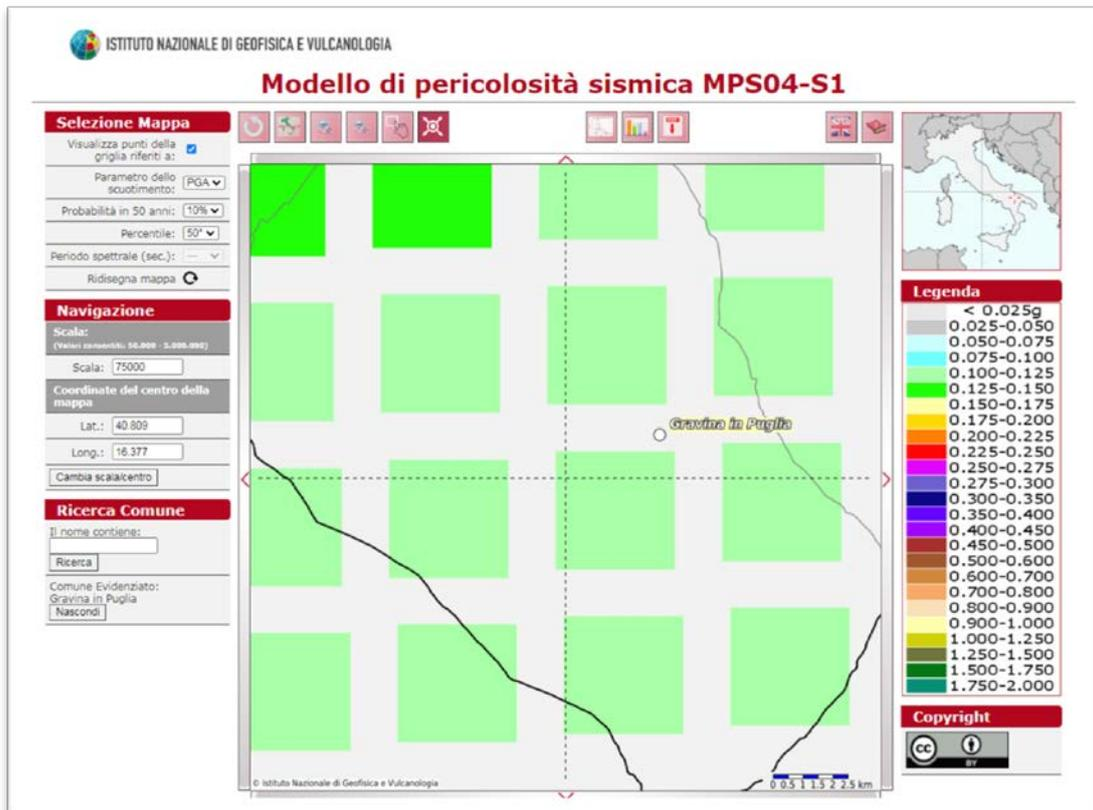
Fig. 12 - Stralcio della mappa interattiva di pericolosità sismica del territorio di Gravina in Puglia. I punti visualizzati si riferiscono a: parametro dello scuotimento  $a_g$ ; probabilità di superamento del 10% in 50 anni.
