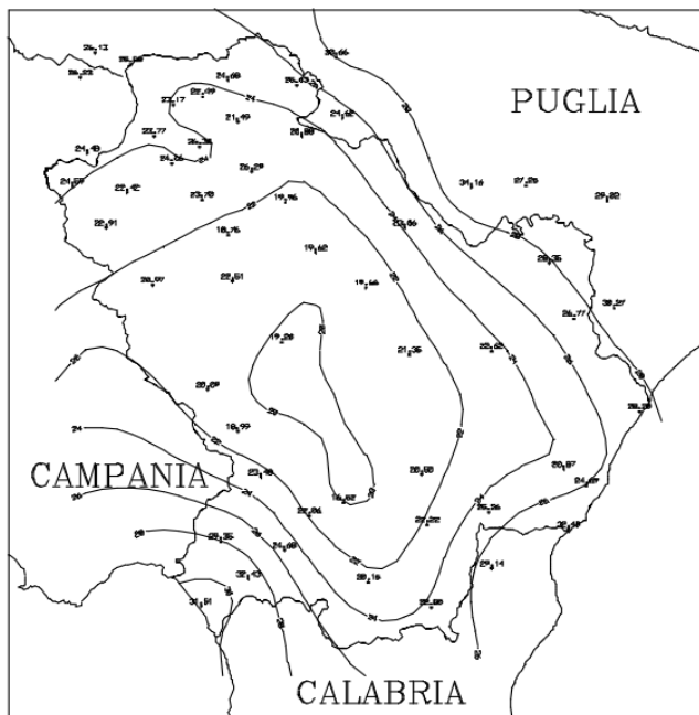
Figura 6-4 Isolinee del coefficiente a della curva di probabilità pluviometrica.
