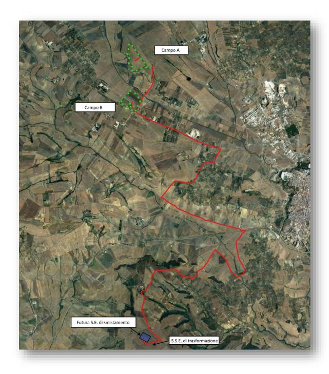
Figura 1 - Percorso dell'elettrodotto interrato MT da realizzare (tratto in rosso)
