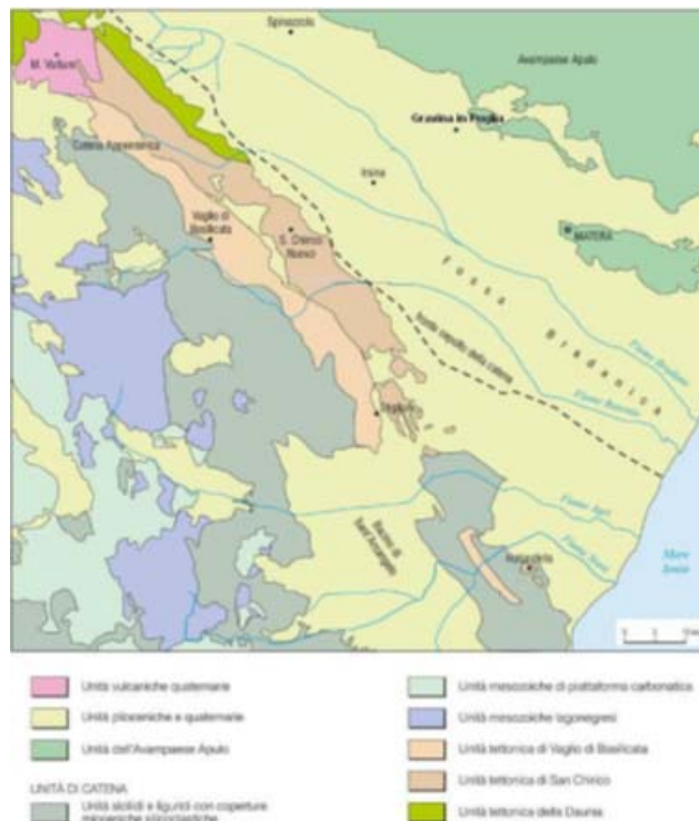
Fig. 2 - Carta schematica della distribuzione delle unità litostratigrafiche principali
