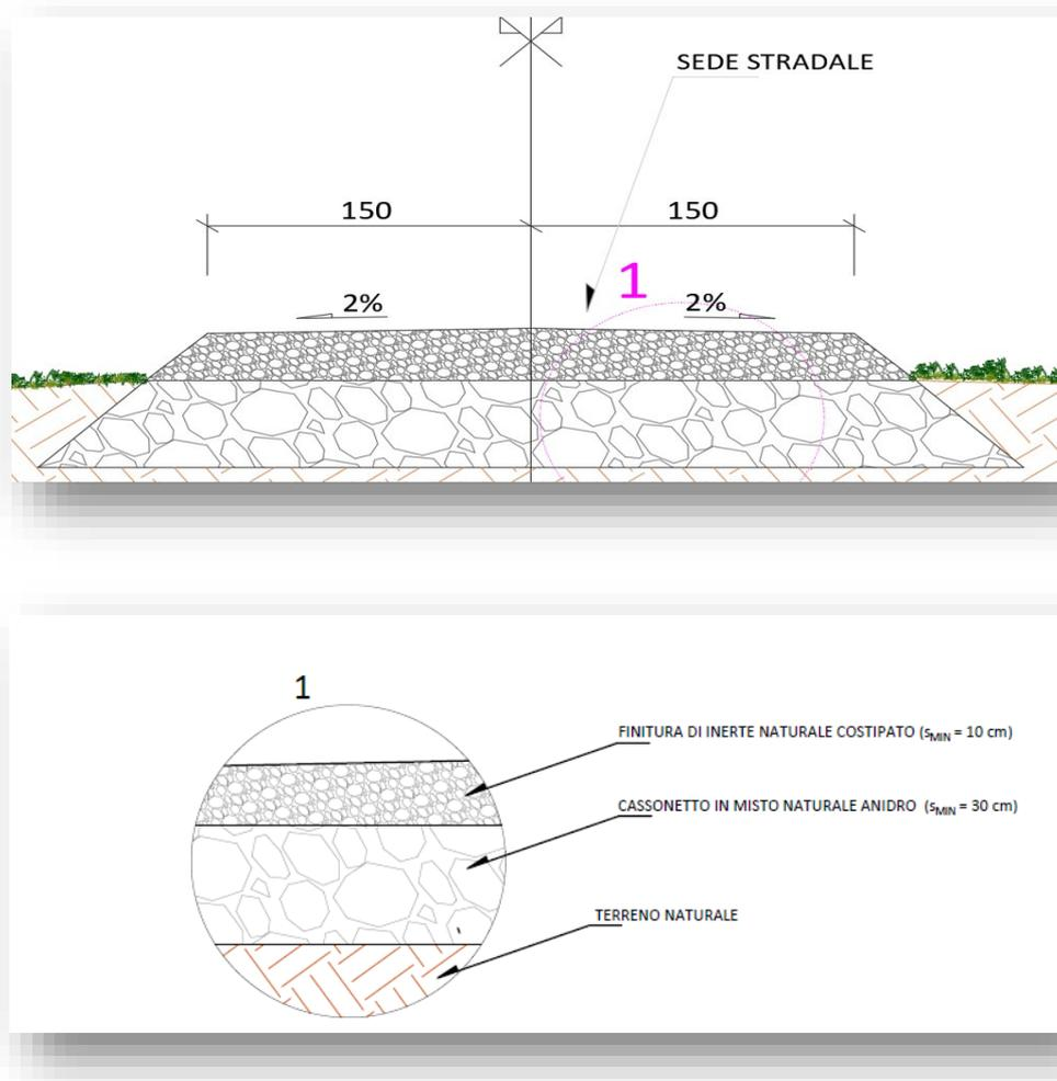
Figura 12-Estratto Elab. R.12 Sezione tipo stradale
