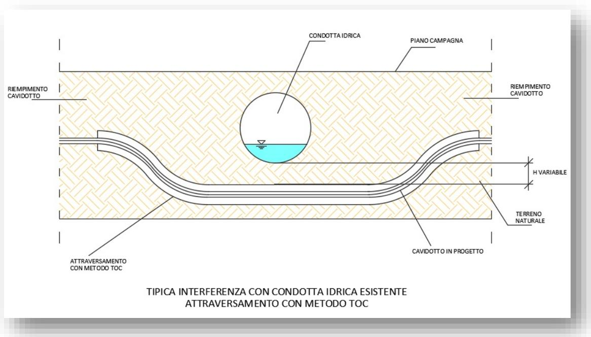
Figura 20 - Schema tipico di risoluzione interferenza con condotte idriche esistenti mediante l'utilizzo di metodo TOC
