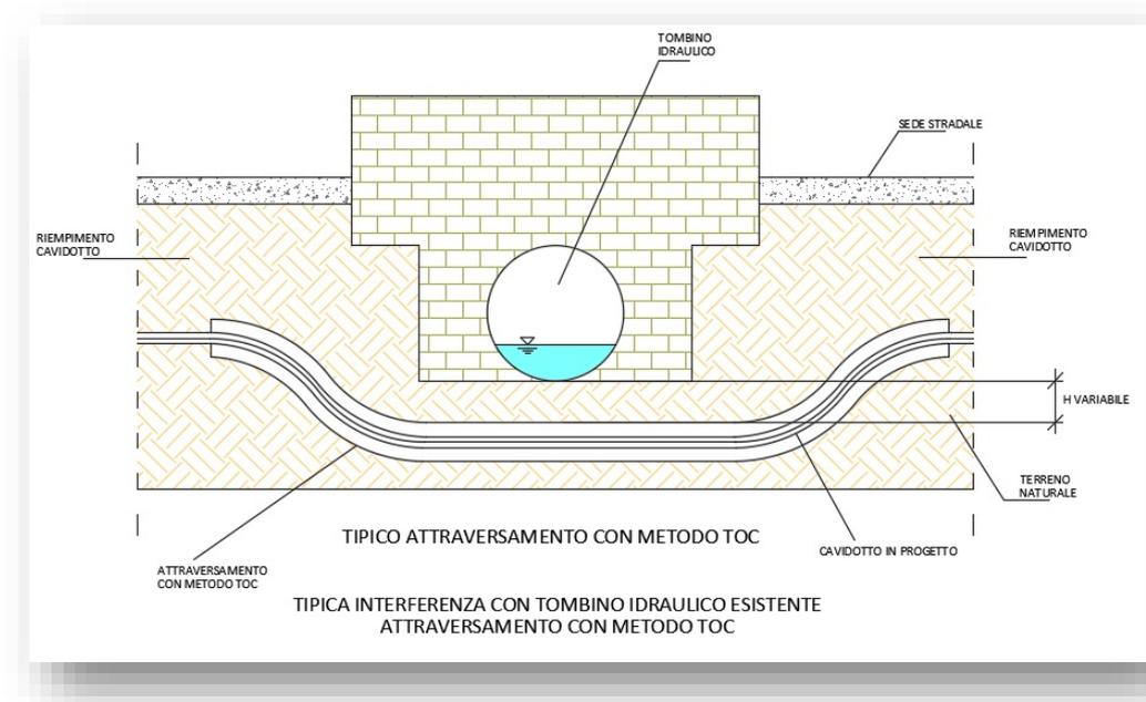
Figura 19- Schema tipico di risoluzione interferenza con tombino idraulico mediante l'utilizzo di metodo TOC
