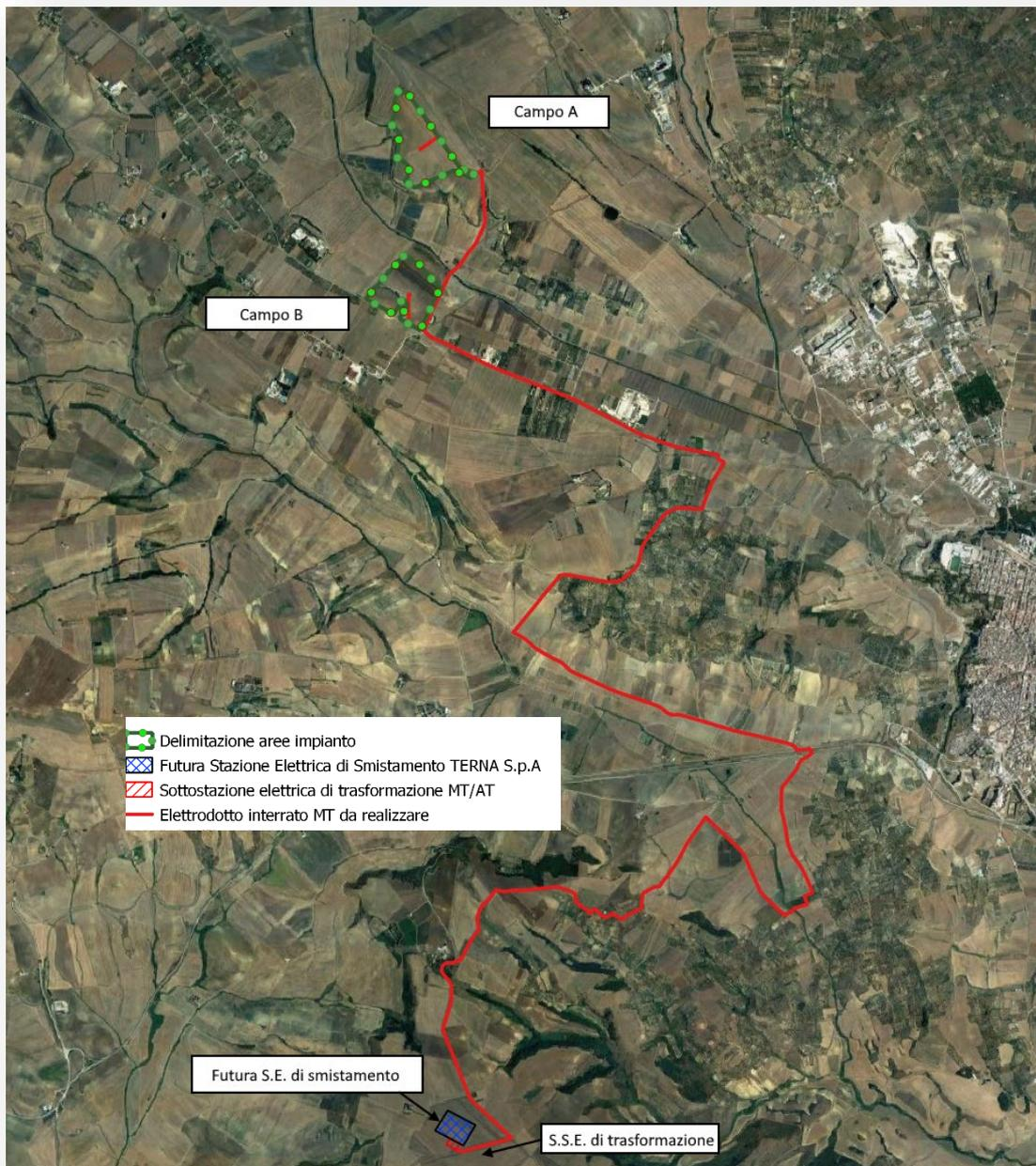
Figura 2 - Percorso dell'elettrodotto interrato MT da realizzare (tratto in rosso)
