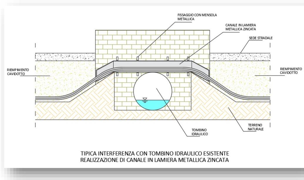
Figura 18 - Schema tipico di risoluzione interferenza con tombino idraulico mediante realizzazione di canale in lamiera metallica zincata
