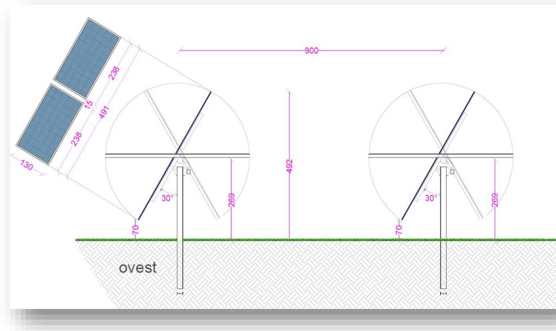
Figura 8 - Sezione tipo impianto con installazione su sistema ad inseguimento solare tipo tracker
