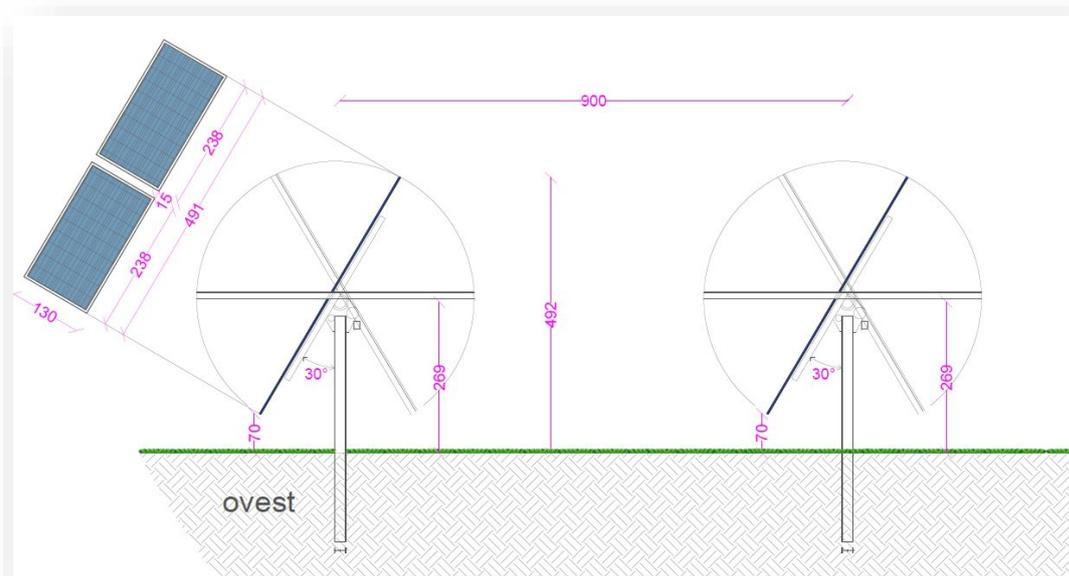
Figura 2 – Sezione tipo impianto nella configurazione tracker
