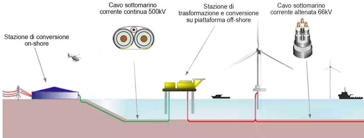
**Figura 3 – Schema funzionale del collegamento elettrico.**
