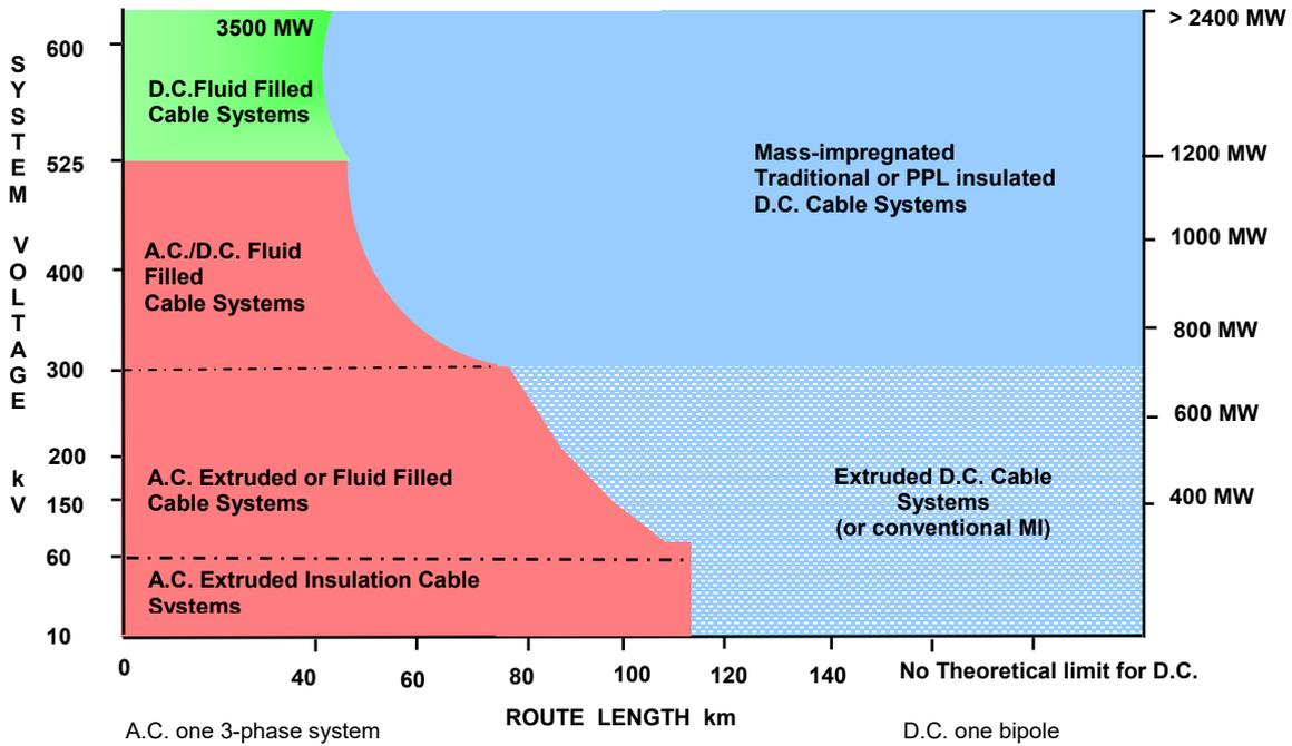
Figura 5 – Tecnologie dei cavi di trasmissione dell’energia.
