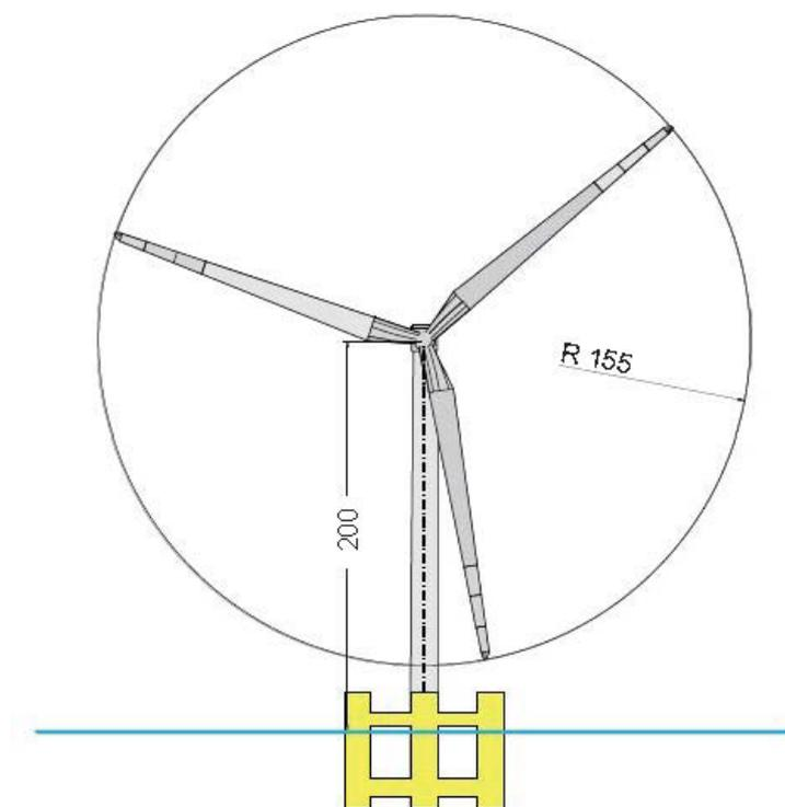
Figura 7 – Aerogeneratore tipo.
