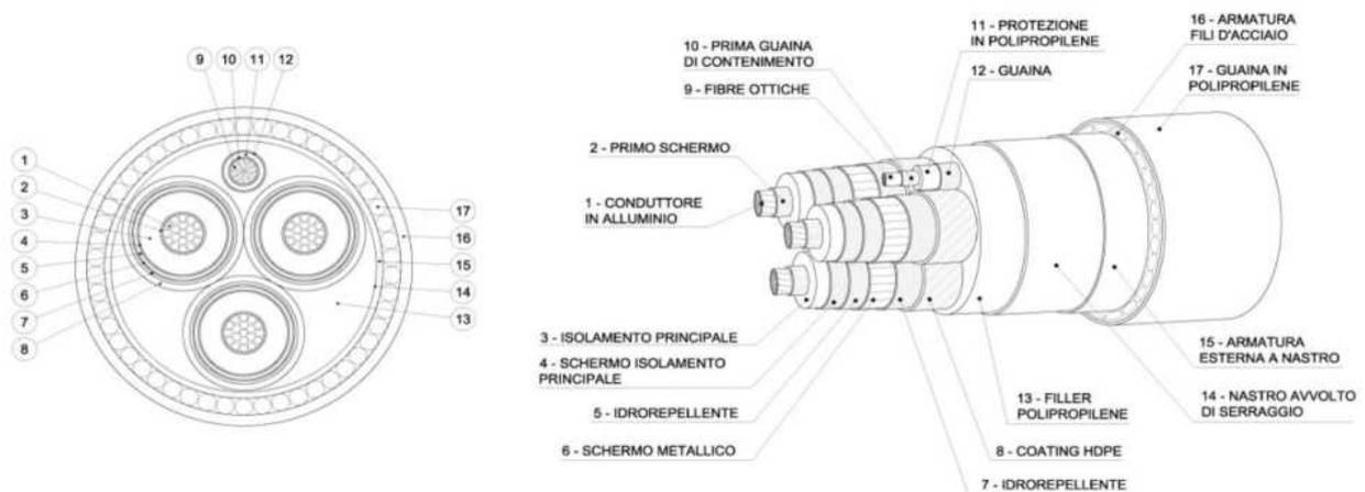
Figura 6 – Struttura cavo a 66 kV.
