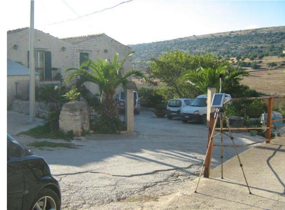
Posizionamento dello strumento fonometrico
