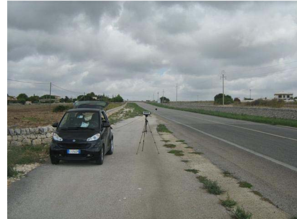
Posizionamento dello strumento fonometrico
