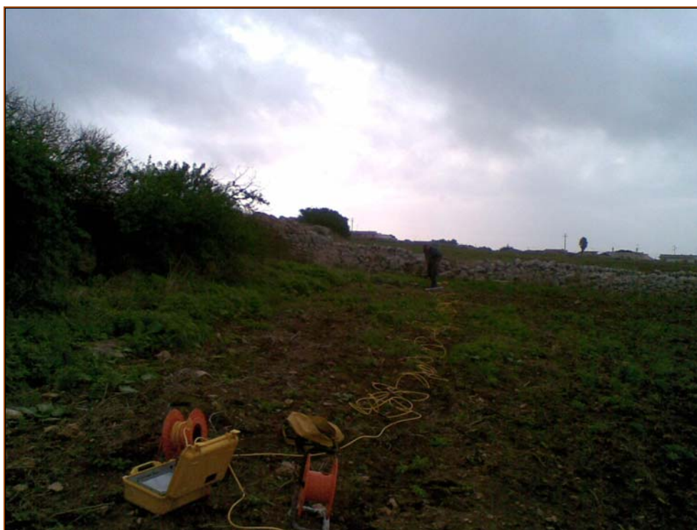
Figura 16. Ubicazione prova e documentazione fotografica – MASW_6-
