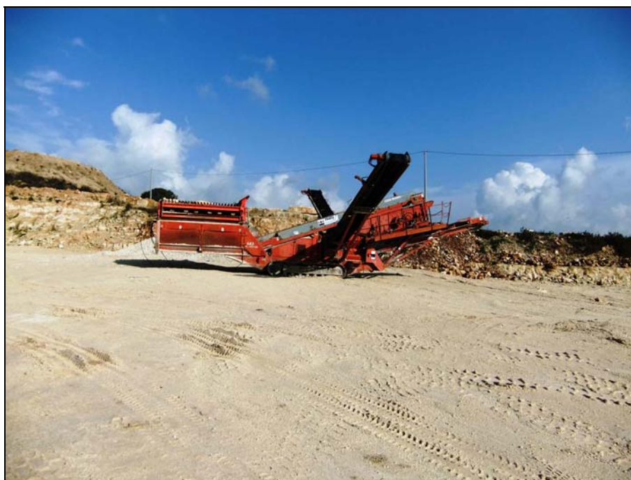
Foto 9 - Impianto di frantumazione semovente Cava Serramontone
