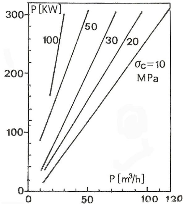
Figura 4 – Abaco per la determinazione delle produttività di una fresa puntuale in relazione alla roccia
