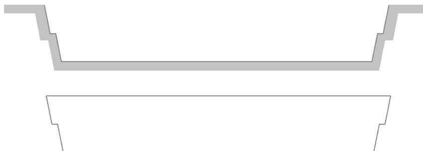
*Figura 18 – Analogia tra la trincea ed la "sezione di scavo" adottata per le analisi*
