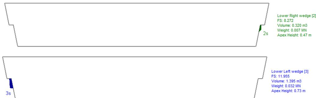
Figura 20 – Possibili cunei di roccia in presenza di una stratificazione inclinata di 15°, per i tratti a
