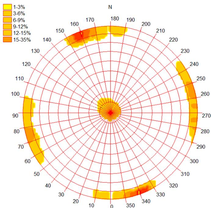
Figura 16 – Diagramma di Schmidt relativo alla stazione geostrutturale ST1
