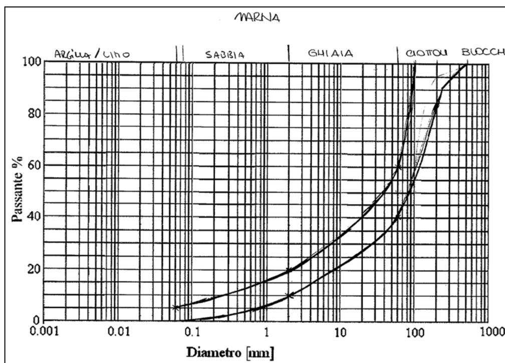
Figura 9 – Fuso granulometrico per le marne del Tellaro
