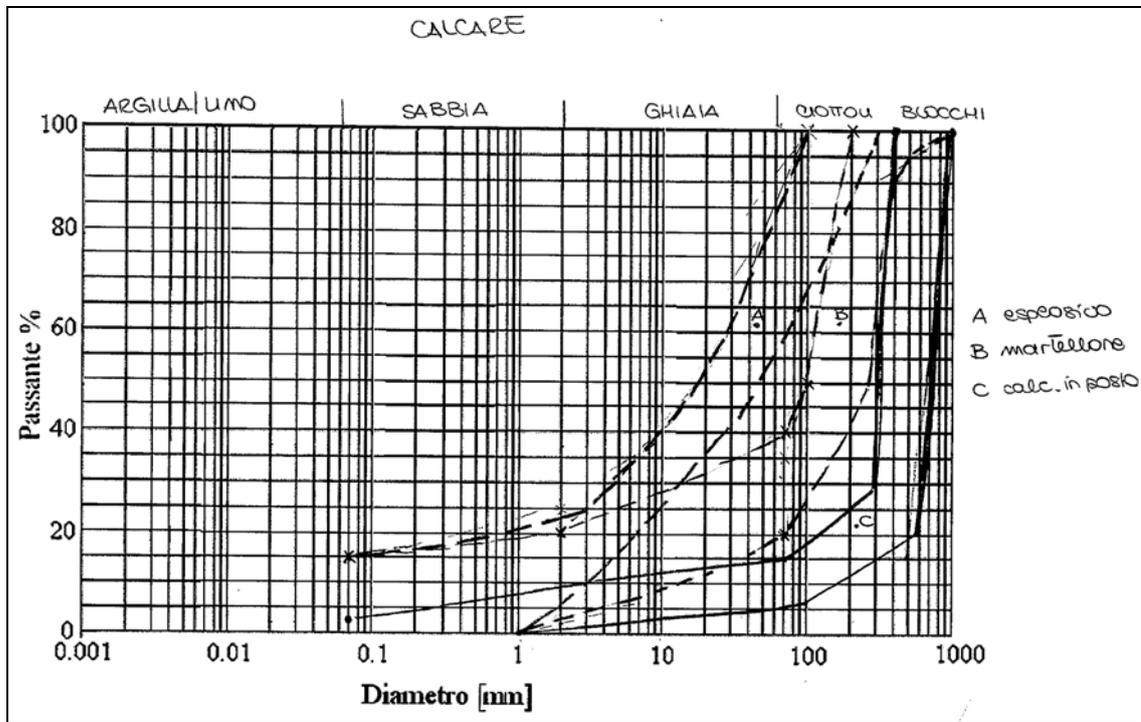
Figura 10 – Fusso granulometrico per i calcari della Formazione Ragusa
