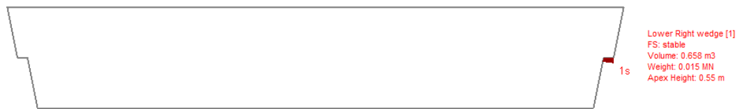
Figura 25 – Possibili cunei di roccia in presenza di una stratificazione inclinata di 15°, per i tratti a
