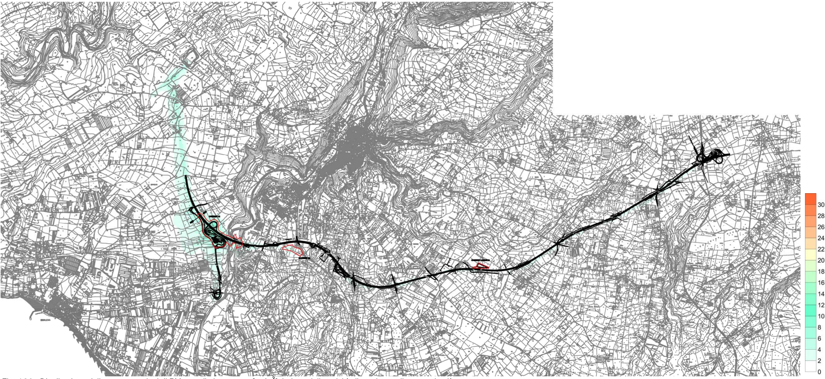
Fig. 4.26 - Distribuzione delle concentrazioni di PM 10 medie in un anno [ \mu\text{g}/\text{m}^3 ], indotte dalle attività di cantiere nello scenario più gravoso.
