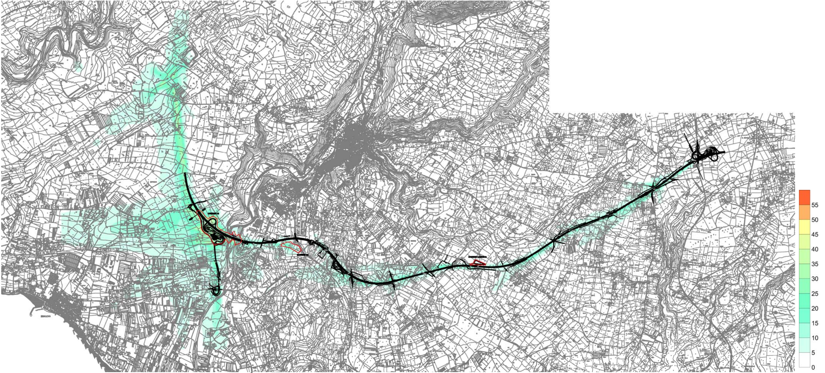
Fig. 4.25 - Distribuzione delle concentrazioni di PM_{10} medie in 24 ore in [\mu g/m^3] , indotte dalle attività di cantiere nello scenario più gravoso.
