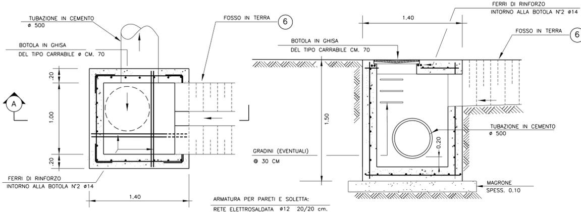
9 PARTICOLARE POZZETTO DI DRENAGGIO
