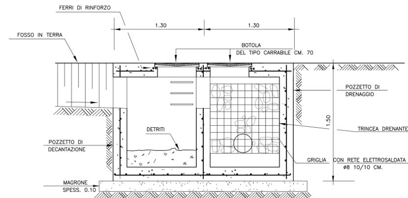
18 PARTICOLARE POZZETTO DI DRENAGGIO
