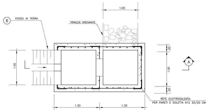
18 PARTICOLARE POZZETTO DI DRENAGGIO
