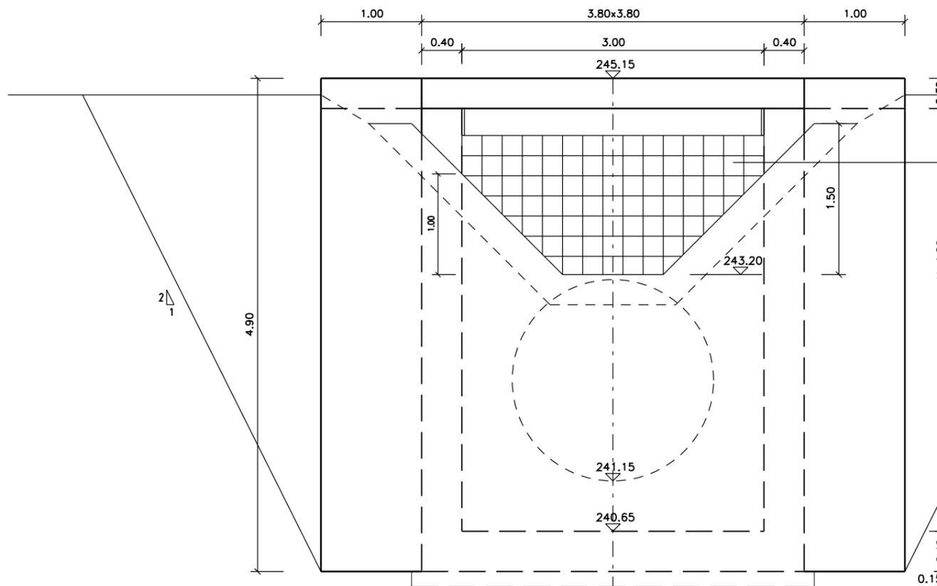
POZZETTO "B-C-D-E-F" - SEZIONE
