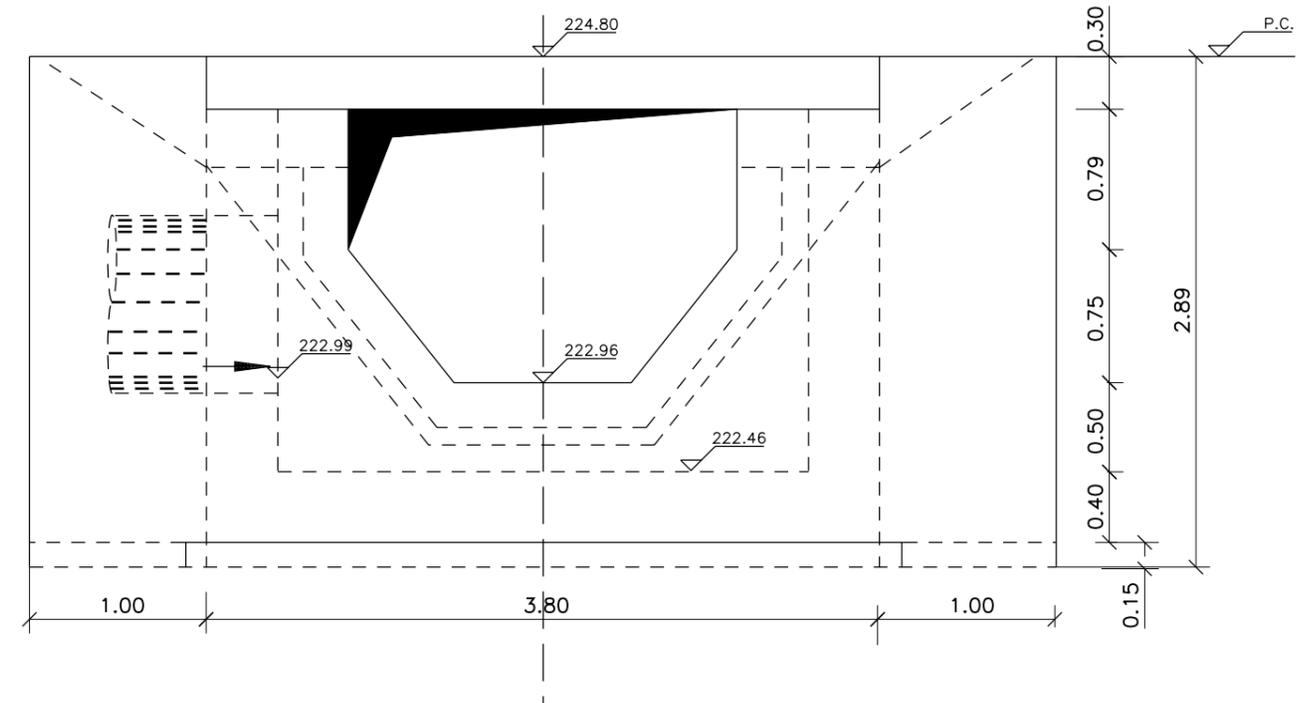
SEZIONE 1-1 POZZETTO A
