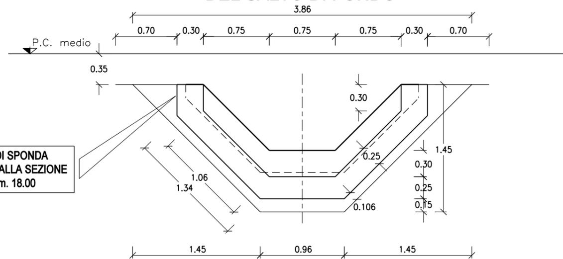
IL SOVRALZO DI SPONDA SI RACCORDA ALLA SEZIONE CORRENTE IN m. 18.00
