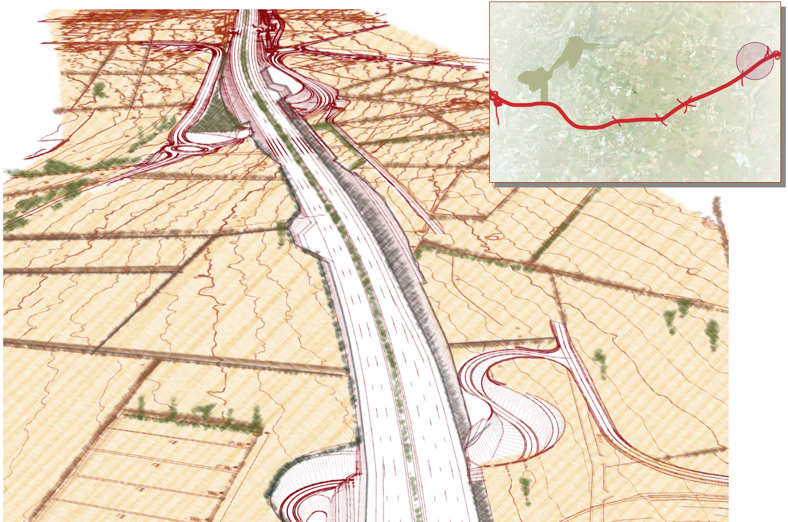
Fig. 8-4 - Lotto 9- Vista a volo d'uccello del tratto iniziale dove si può notare l'andamento ora in trincea ora in rilevato del tracciato
