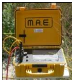
Fig. 2: sismografo multicanale M.A.E. modello A 6000 S.
