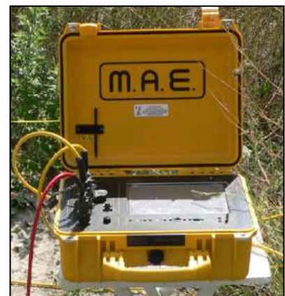
Fig. 3: sismografo multicanale M.A.E. modello A 6000 S.
