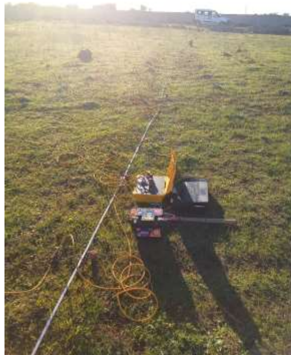
FOTO 4A: postazione di energizzazione SS4
