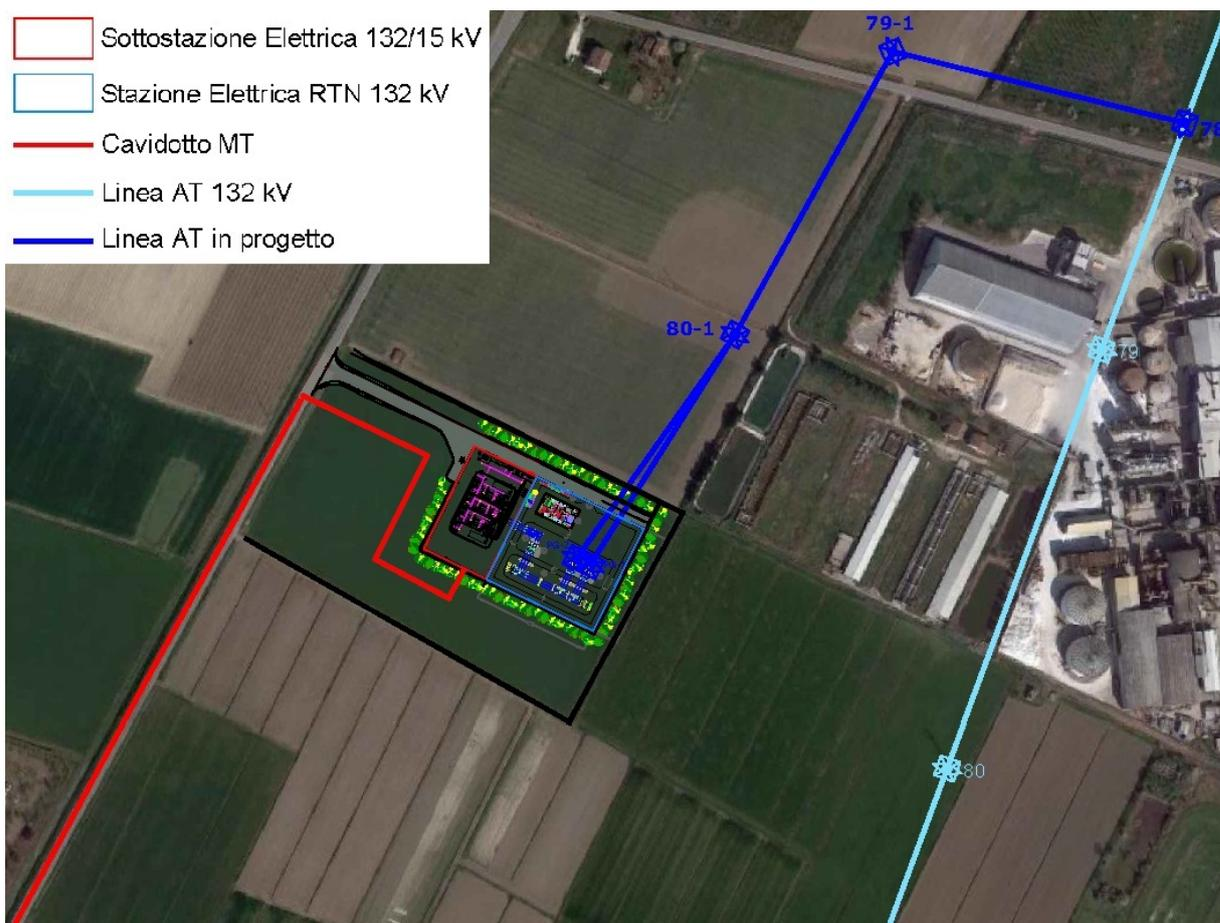
Figura 5-2 – Schema delle opere accessorie presso la nuova stazione RTN
