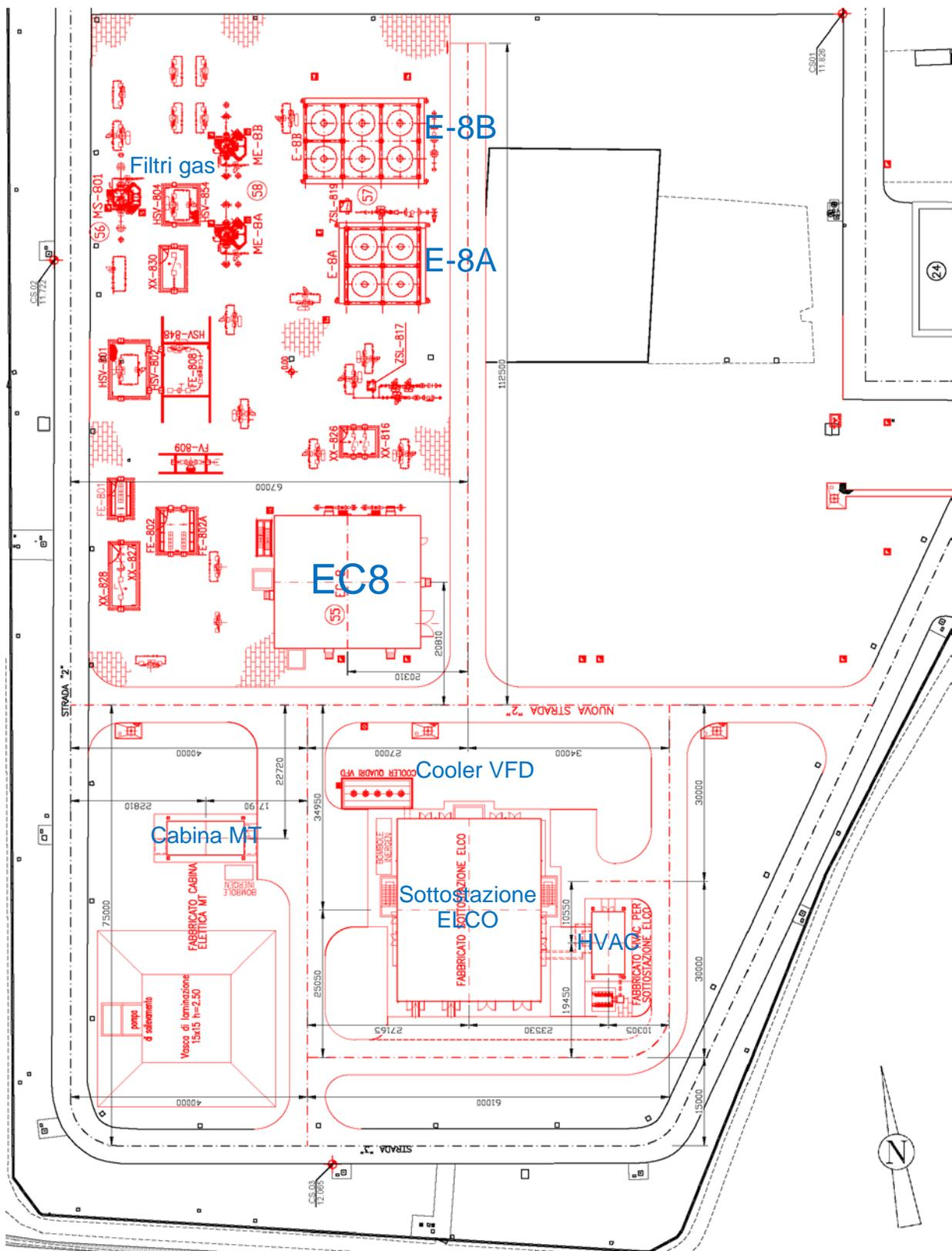
Figura 5-1 – Stralcio della planimetria della centrale, con evidenziazione delle apparecchiature di prossima costruzione (rosso)
