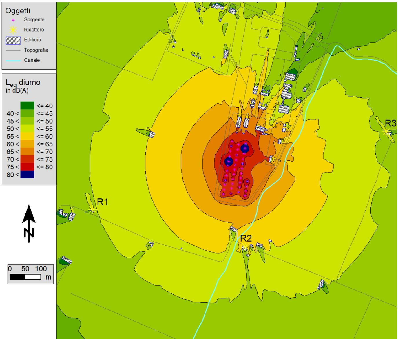
Figura 6.3.1-1 – Mappa isofonica delle emissioni prodotte dalle sole sorgenti di cantiere, in uno scenario tipo durante la fase più intensa della costruzione, nel periodo diurno, alla quota di 2 m dal piano campagna
