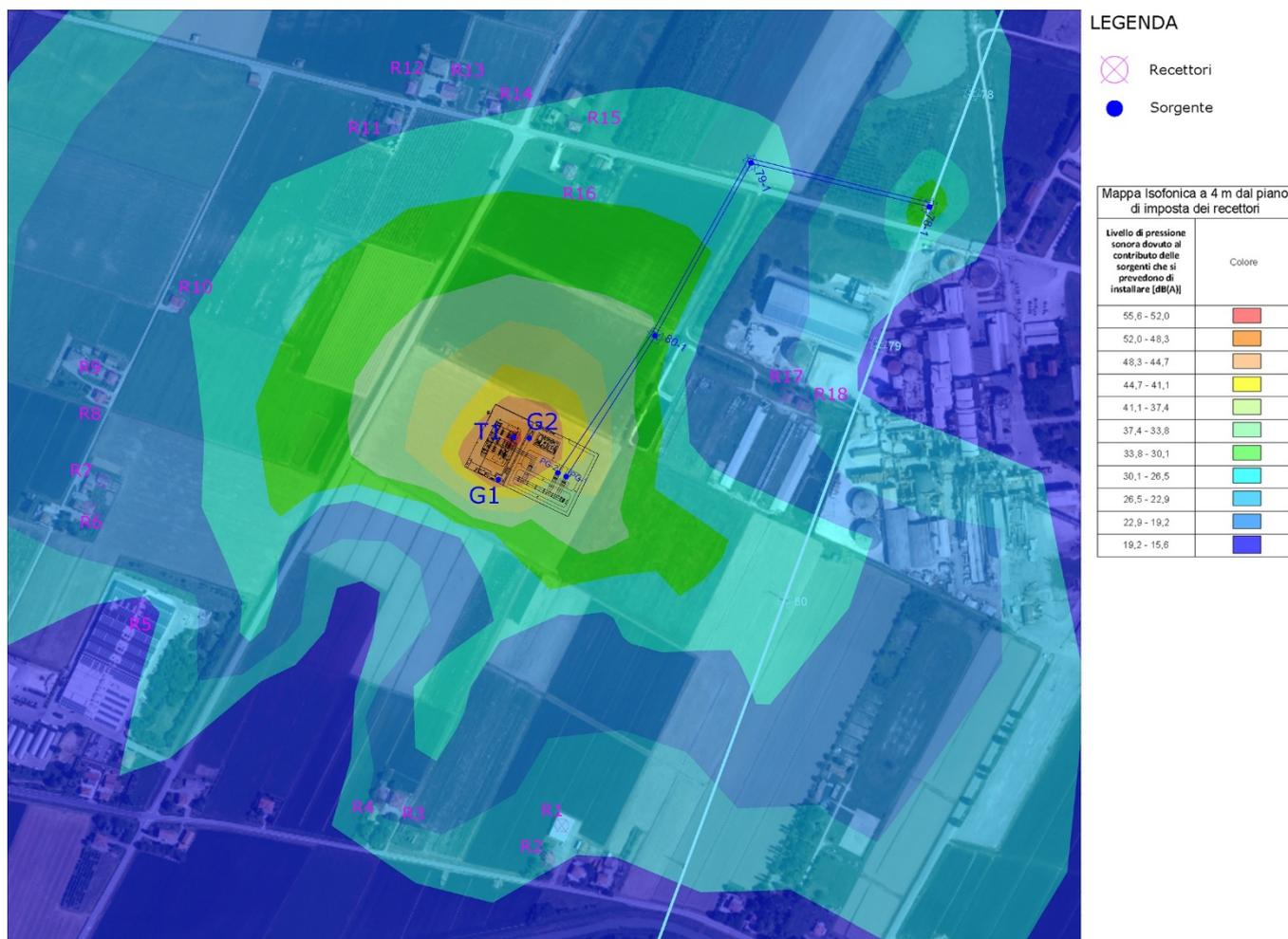
Figura 6.4.2-2 – Mappa isofonica delle emissioni prodotte in fase di esercizio dalle nuove sorgenti relative alle opere accessorie nello scenario di emergenza (con gruppi elettrogeni attivi), nel periodo diurno o notturno, alla quota di 4 m dal piano campagna. La scala dei colori è diversa rispetto alla figura precedente.
