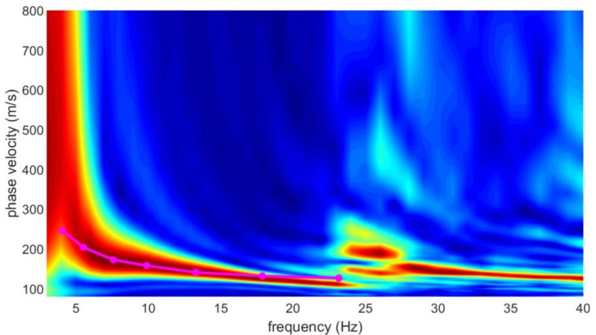
Figura 17 – MASW2 area esterna. Spettro frequenza-vel. fase medio, calcolato sulla base di 2 diverse acquisizioni dei dati sismici.
