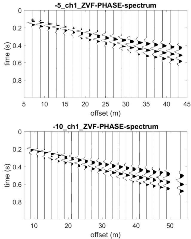
Figura 16 – MASW2 area esterna. Sismogrammi acquisiti e successivamente puliti dei 2 siti di energizzazione
