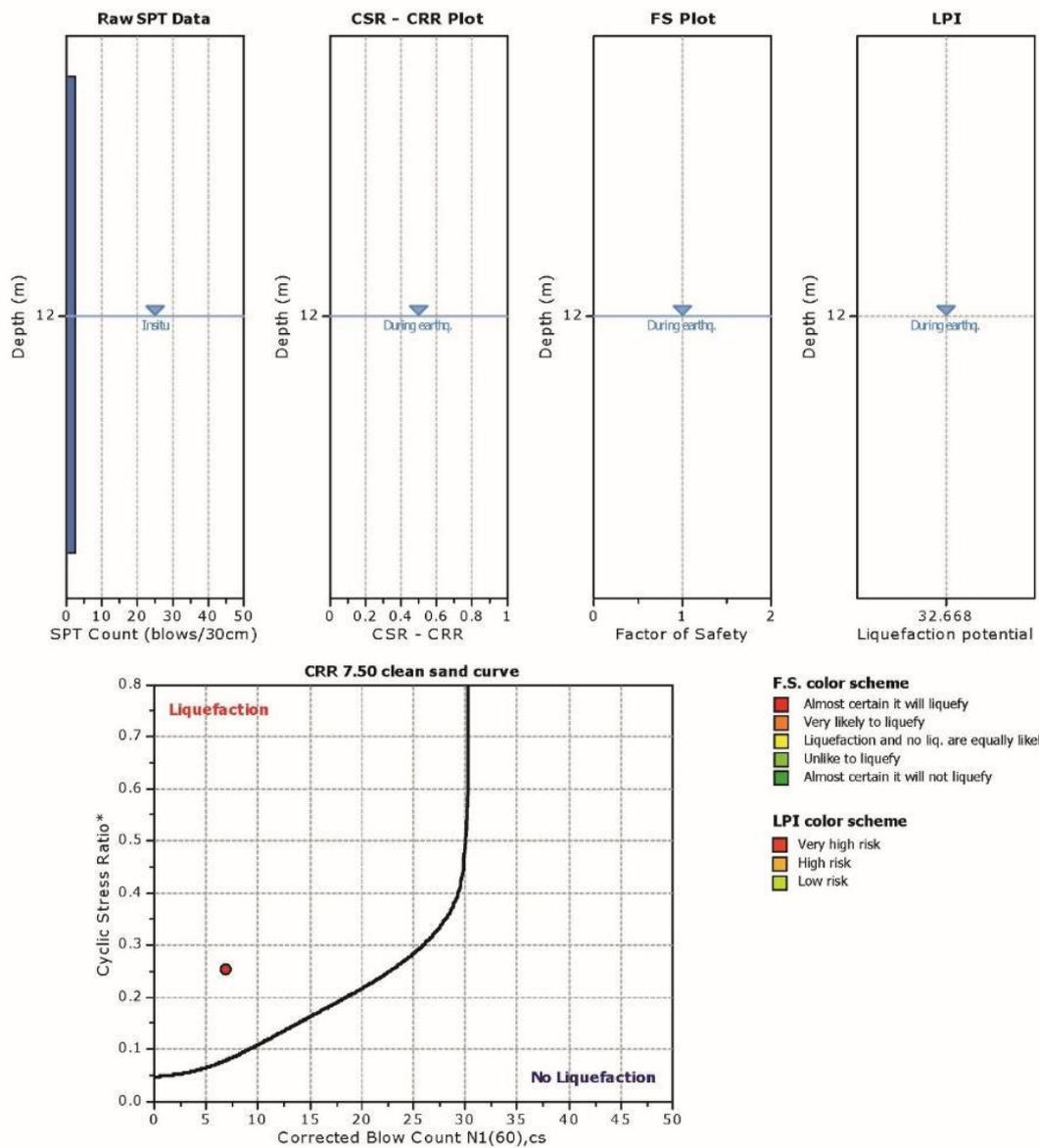
**Figura 4.3: Sintesi delle verifiche sui livelli potenzialmente liquefacibili – Sondaggio SG02**
