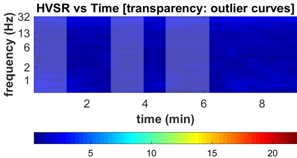
Figura 26 – HVSr1. Segnale acquisito. In alto è riportato il segnale acquisito dopo la pulizia. In basso è riportato il diagramma frequenza vs tempo della continuità del segnale HVSr durante l'acquisizione.
