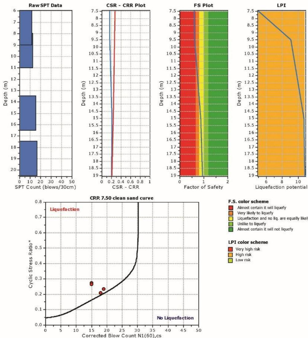
**Figura 4.4:** Sintesi delle verifiche sui livelli potenzialmente liquefacibili – Sondaggio SG04
