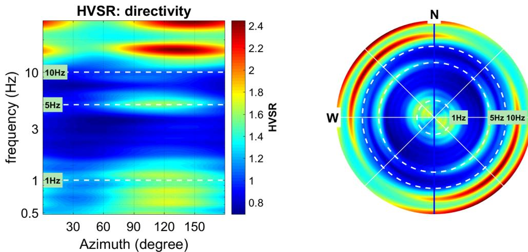
Figura 31 – HVS2. Diagramma della direzionalità del rapporto H/V inerente la direzione di provenienza del segnale sul semipiano orizzontale.
