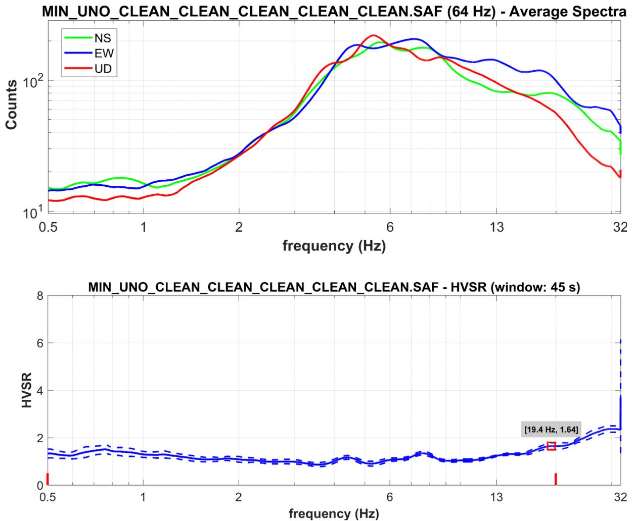
Figura 27 HVSR1. In alto è riportato il diagramma in cui sono raggruppati gli spettri medi di tutte e tre le componenti V, N, E. In basso è riportato il diagramma del segnale HVSR nel dominio delle frequenze con indicazione dell'intervallo di frequenza in cui sono stati verificati i criteri del progetto SESAME. Si noti il picco in corrispondenza del valore 19.4 Hz nell'intervallo 0.5 - 20 Hz.
