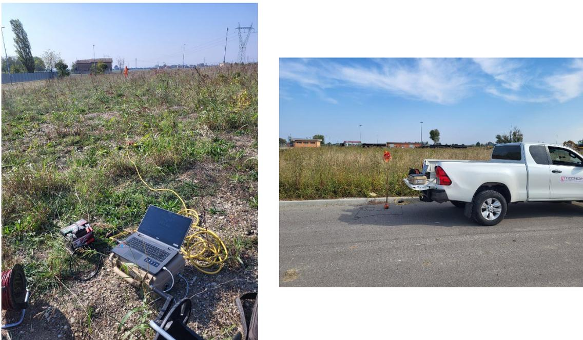
*Figura 4 – Sito STOGIT, indagini MASW1 area interna (Sinistra) e MASW4 area interna (destra).*
