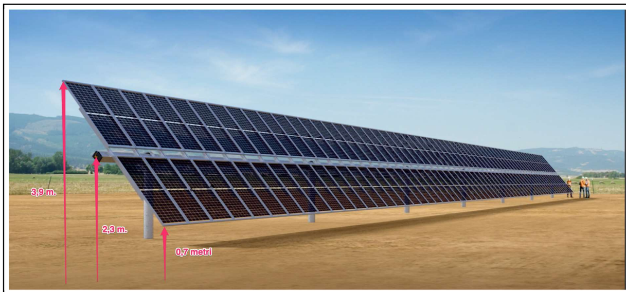
Fig. 12-2 Inseguitore Mono-assiale NX Horizon Gemini – Rappresentazione struttura realizzata
