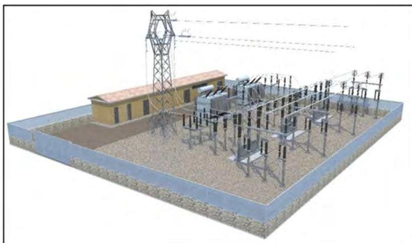
Figura 2-10 Sottostazione tipo con apparecchiatura ad alta tensione, trasformatore, quadri di media tensione e armadio di comando
