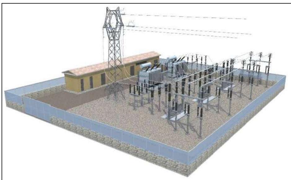
Figura 8-1 Sottostazione tipo con apparecchiatura ad alta tensione, trasformatore, quadri di media tensione e armadio di comando
