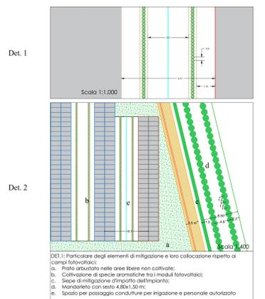
Particolare profilo tipo del posizionamento delle strutture
