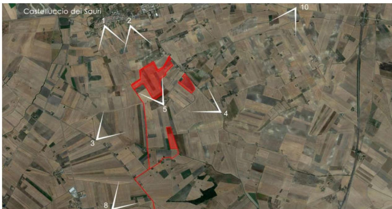
**Figura 1:** Coni visivi utilizzati per la valutazione della percezione paesaggistica e riferimenti ai punti di osservazione che rappresentano una specifica tipologia di percezione dell'impatto dell'impianto fotovoltaico da mitigare.
