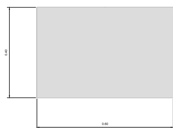
SEZIONE TRAVE DI FONDAZIONE: FABBR. A
