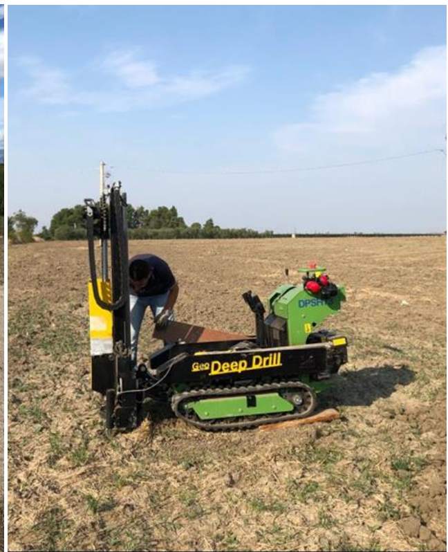
Fig.6b – Immagini degli stendimenti sismici e della prova penetrometrica
