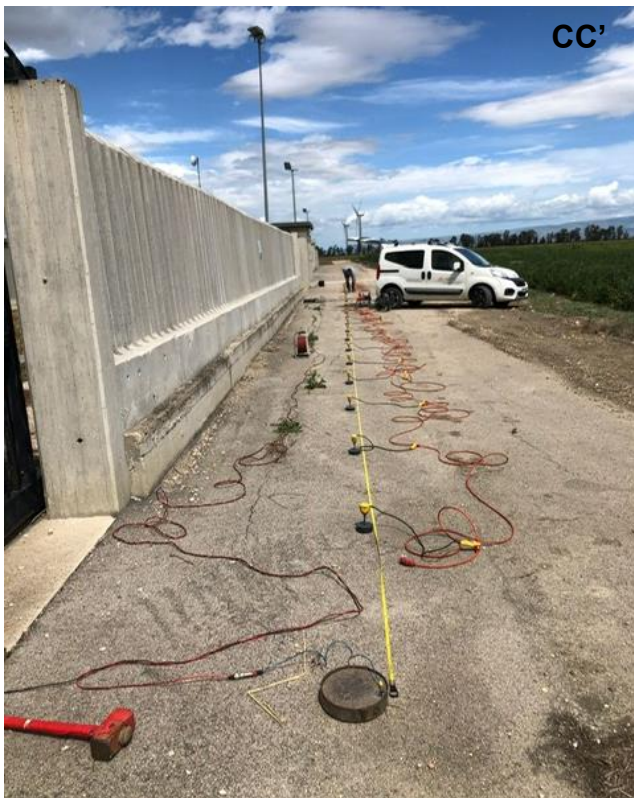
Fig.6b – Immagini degli stendimenti sismici e della prova penetrometrica
