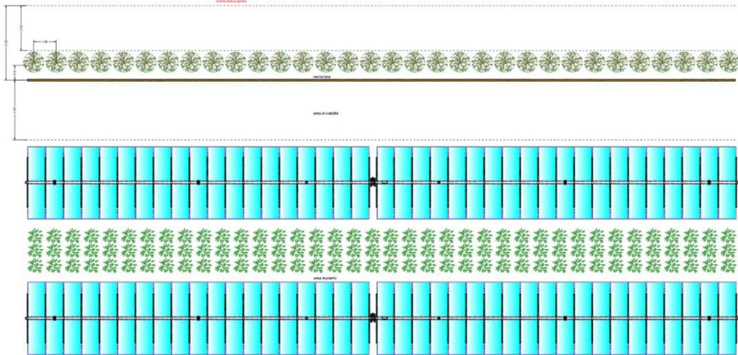
**Figura 2-2: Soluzione Agro-Solare: barriera verde perimetrale, viabilità interna, tracker e componente agronomica**
