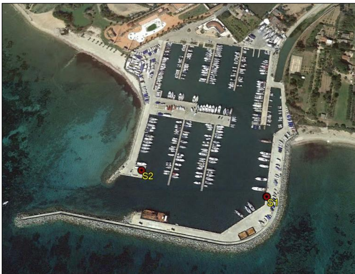
Figura 11. Posizione dei Sondaggi effettuati in data 01/08/2019.
