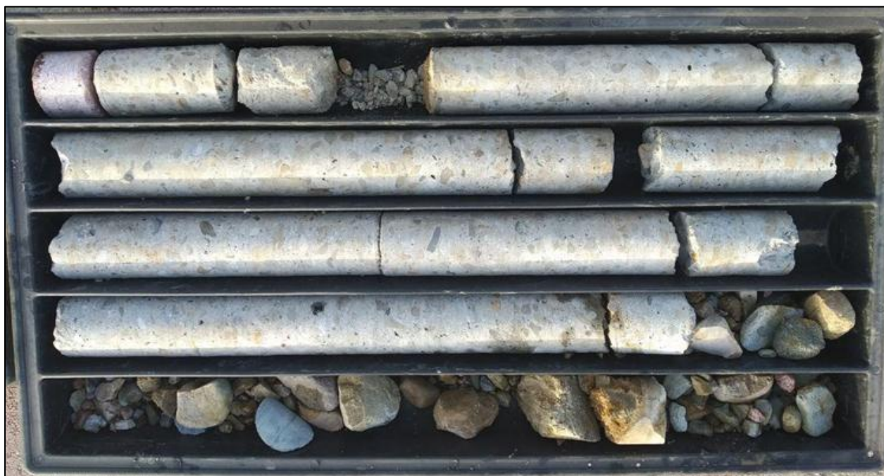
Figura 15. Foto Sondaggio 2, da 0m (in alto) a 5m (in basso).
