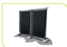
Nella versione **autoportante con montaggio su montanti verticali** di sostegno il pannello è provvisto di asole laterali per l'inserimento dei tubi metallici con diametro compreso tra 40 e 48 mm, utilizzando ad esempio i tubi innocenti per ponteggio. I montanti possono essere inseriti nei blocchi di cemento per recinzioni da cantiere oppure fissati al suolo o ai basamenti tipo new jersey.
