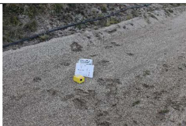
Fig. 19 - Indagine geofisica mediante tecnica dei rapporti spettrali o hvsr – TRO8
