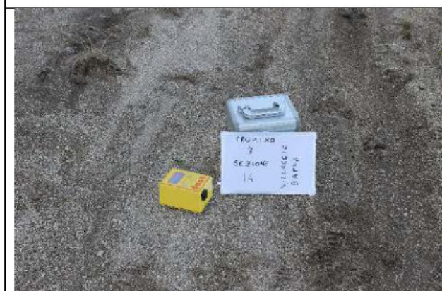
Fig. 18 - Indagine geofisica mediante tecnica dei rapporti spettrali o hvsr – TRO7
