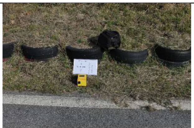
Fig. 15 - Indagine geofisica mediante tecnica dei rapporti spettrali o hvsr – TRO4
