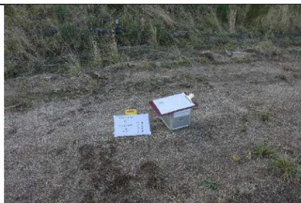
Fig. 17 - Indagine geofisica mediante tecnica dei rapporti spettrali o hvsr – TRO6
