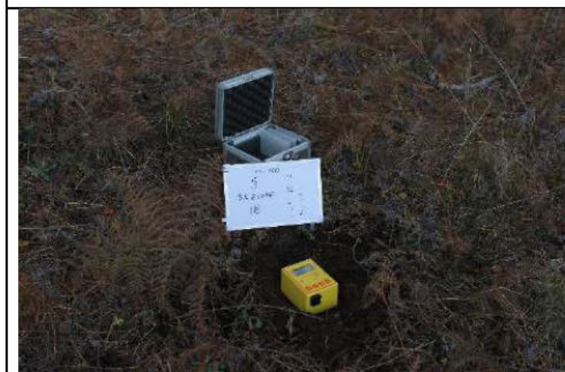
Fig. 20 - Indagine geofisica mediante tecnica dei rapporti spettrali o hvsr – TRO9
