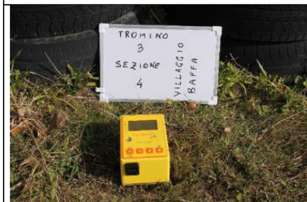
Fig. 14 - Indagine geofisica mediante tecnica dei rapporti spettrali o hvsr – TRO3
