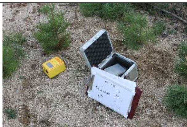
Fig. 21 - Indagine geofisica mediante tecnica dei rapporti spettrali o hvsr – TRO10
