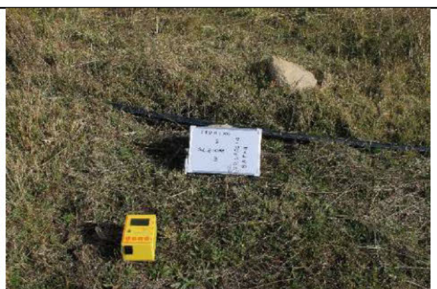
Fig. 13 - Indagine geofisica mediante tecnica dei rapporti spettrali o hvsr – TRO2
