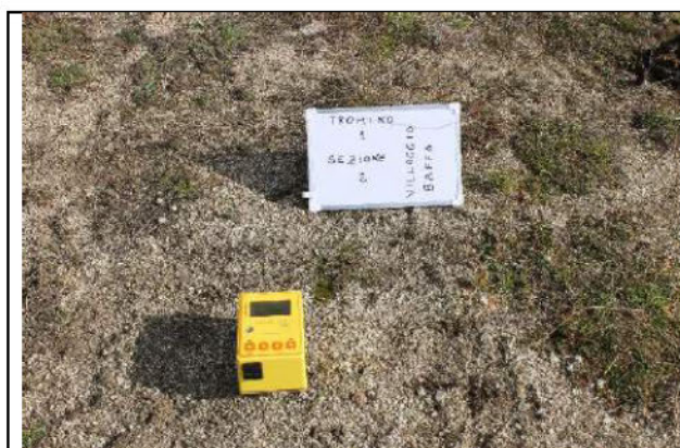
Fig. 12 - Indagine geofisica mediante tecnica dei rapporti spettrali o hvsr – TRO1
