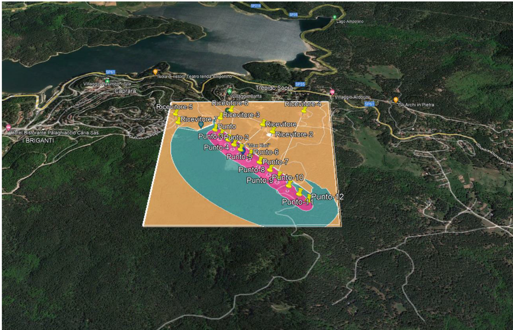
Fig.02 – Planimetria dell'area: posizione della sorgente, dei recettori e del punto di misura
