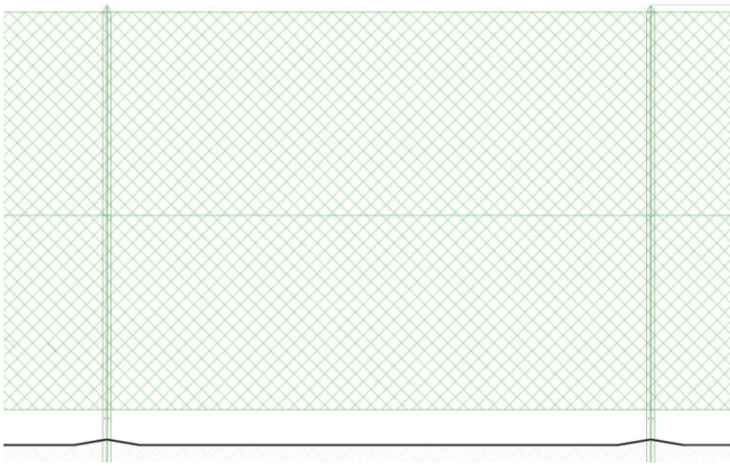
Figura 117: Particella recinzione perimetrale con apertura inferiore (20-30 cm).
