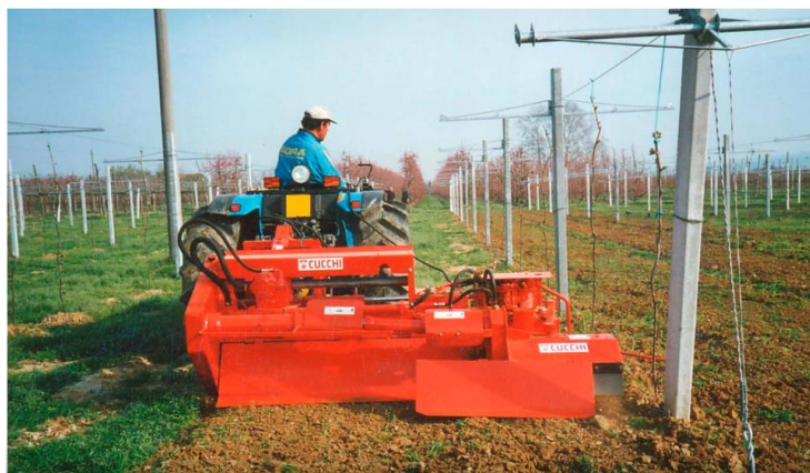
Figura 6: Esempio di fresatrice interceppo per le lavorazioni sulla fila (fonte Cucchi Macchine Agricole).
