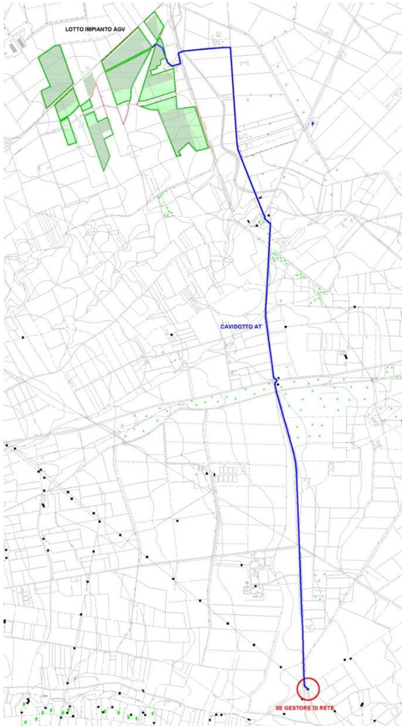
Figura 22: Stralcio mappa CTR Fogli 547060-547100 con indicazione del campo AGV e della linea di connessione.
