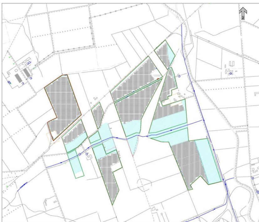
Figura 37: Planimetria layout impianto con indicazione delle fasce di rispetto fluviali.
