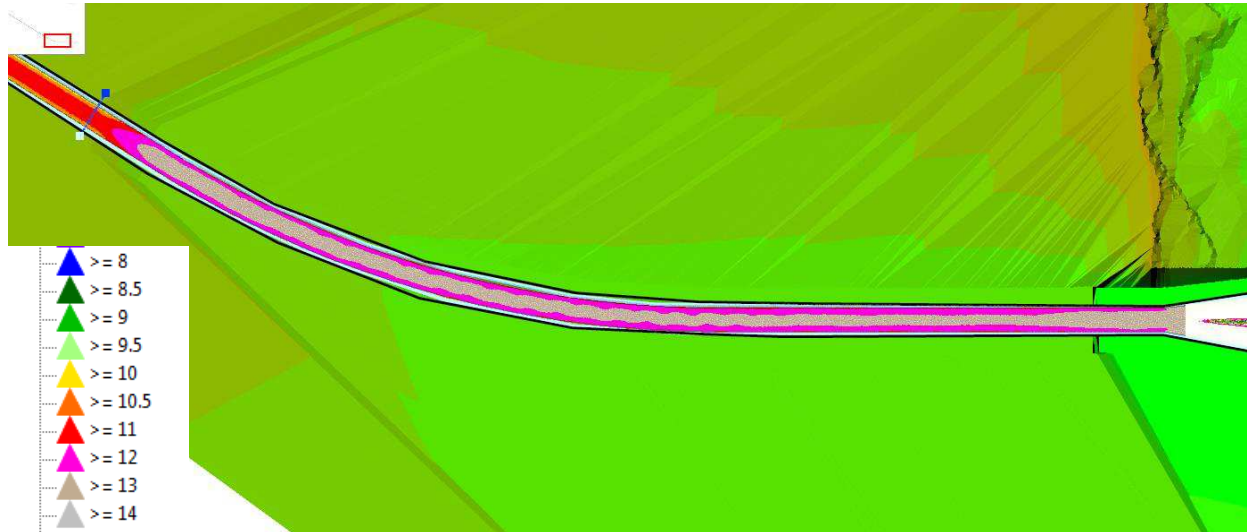
Figura 23 –mappa delle velocità nel tratto terminale della galleria (Tratto 5) – Q = 332 \text{ m}^3/\text{s}
