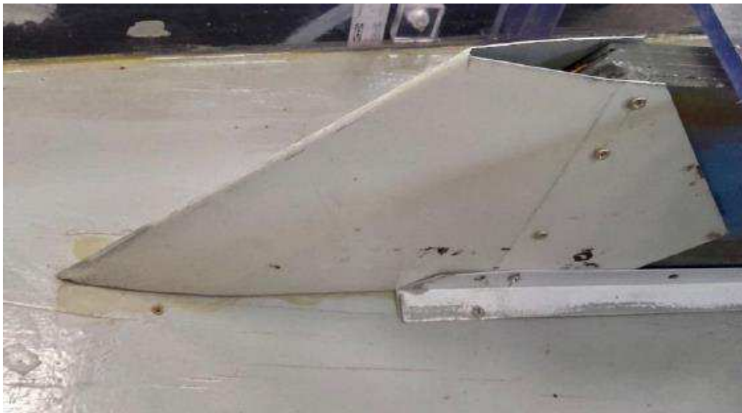
Figura 26 – Testa del setto con nuova conformazione apportata su modello fisico
