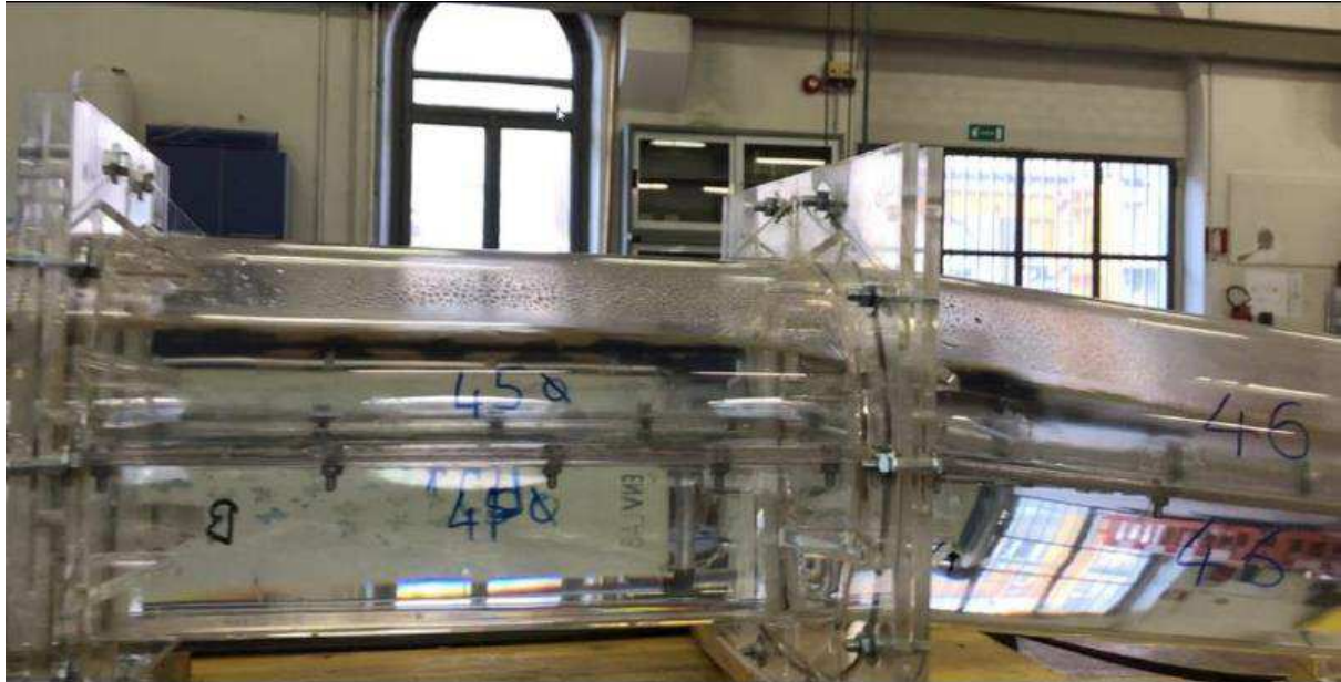
Figura 22 –Funzionamento della galleria al termine del tratto rettilineo subito più a monte dello scivolo con pendenza 11.9% per portata pari a 67 l/s (332 mc/s nel prototipo)
