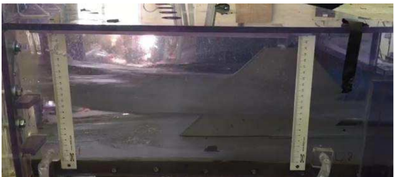
Figura 27 – Effetti di riflessione del getto da parte del setto nel manufatto di restituzione. In alto setto verticale, in basso setto inclinato di 45° Q = 67 \text{ l/s} (332 mc/s nel prototipo)
