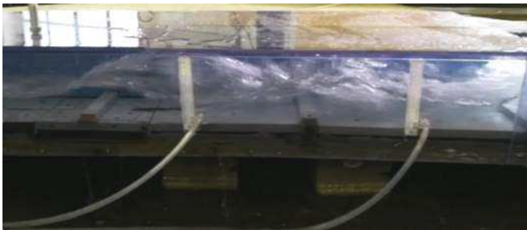
Figura 25 –Effetto di dissipazione delle soglie durante i test su modello fisico Q = 67 \text{ l/s} ( 332 \text{ mc/s} nel prototipo)
