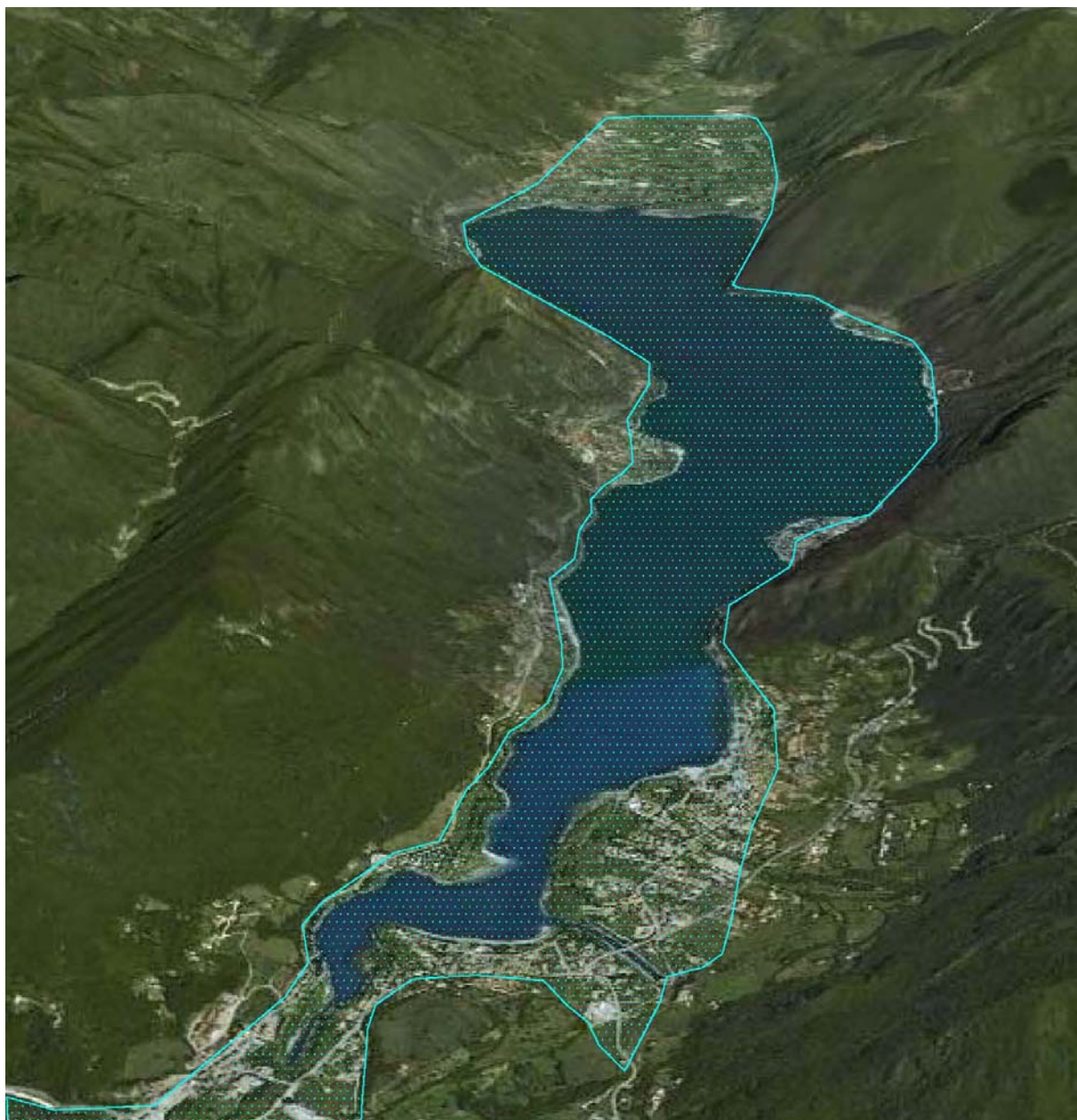
Figura 21: vista 3D dell'ipotesi di livelli a 378 m slm con la quasi totale sommersione dei centri abitati.
