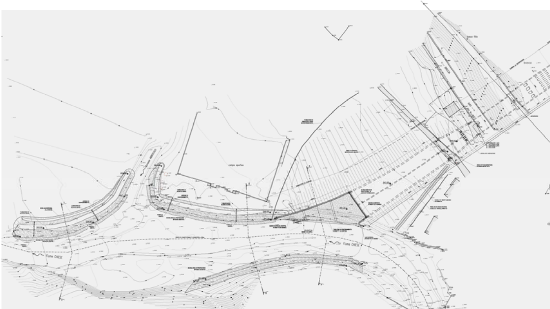
Figura 43 : Canale di restituzione a valle della galleria.
