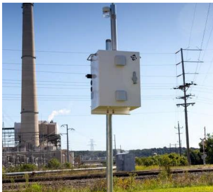
Figura 5 - Esempio di postazione fissa di analizzatori di polveri a principio di misura fotometrico
