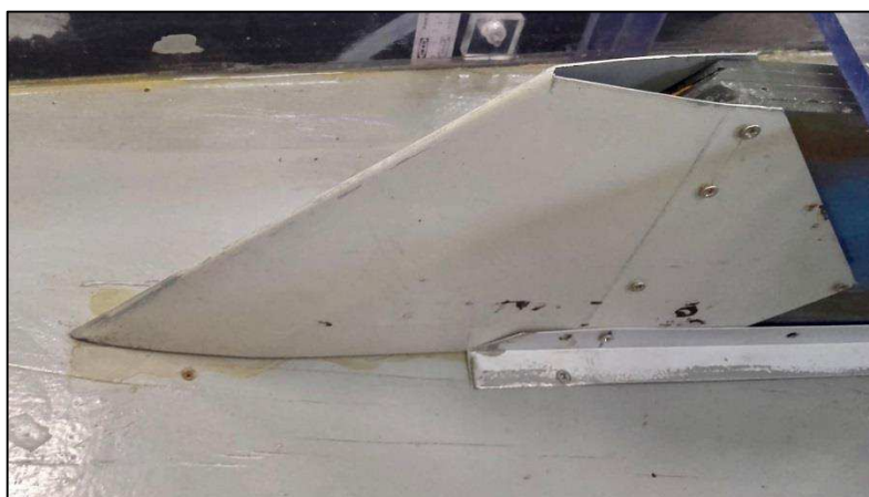
Figura 4 – Testa del setto con nuova conformazione apportata su modello fisico
