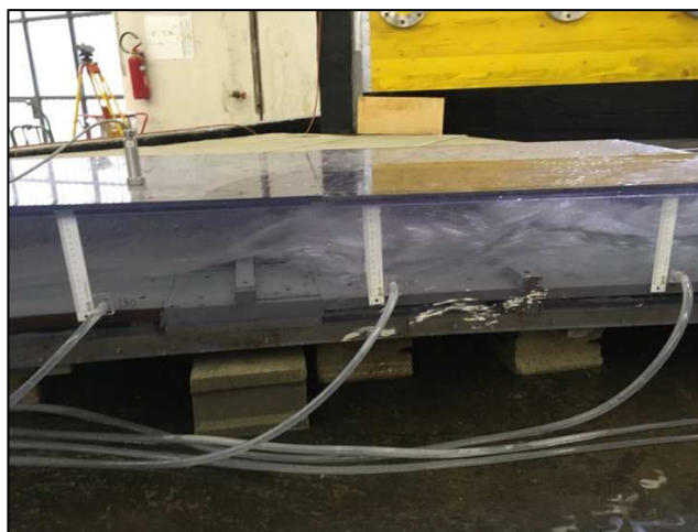
Figura 17. Canale di restituzione: sono visibili le soglie di fondo perpendicolari al moto
