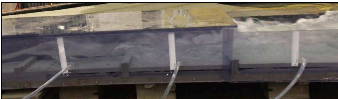
Figura 114. Profilo di corrente lungo il canale di sbocco con effetto di dissipazione delle soglie sporgenti di altezza 2 cm per Q=67 l/s
