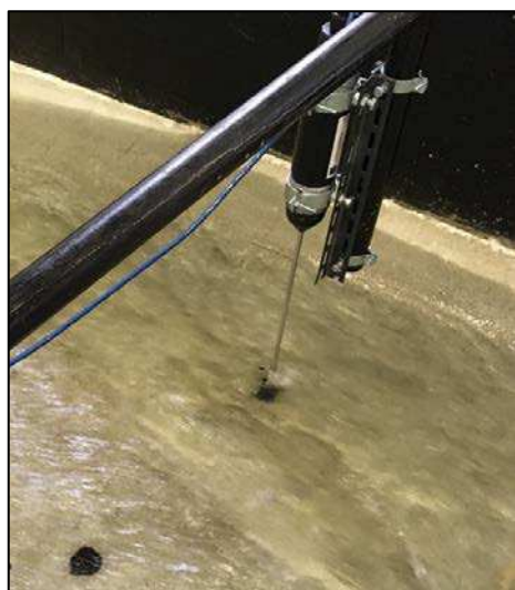
Figura 34. Vectrino installato alla sezione di confluenza nel punto di misura V7 e caratteristiche tecniche
