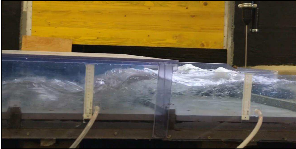
Figura 6 – Effetto di sovrizzo dovuto alla quarta soglia trasversale e conseguente risalto idraulico localizzato tra la sezione 32 e la terza soglia trasversale per Q galleria=45 l/s (prova 2)
