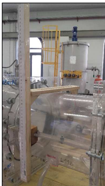
Figura 29. Asta idrometrica appositamente realizzata per le misure lungo la galleria
