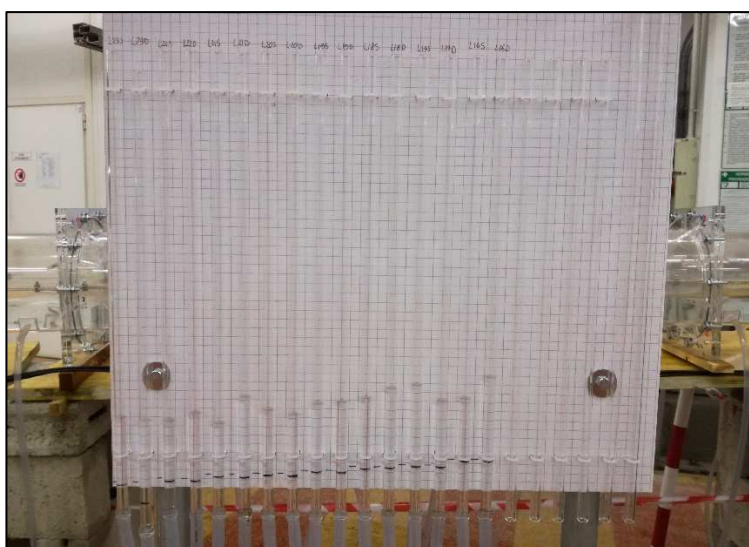
Figura 28. Piezometri a tubo aperto su pannello millimetrato (1 di 3) utilizzati per le misure di livello
