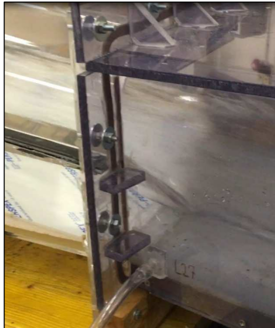
Figura 116. Effetto di scia in parete in corrispondenza del raccordo tra la galleria a sezione policentrica e le pareti del canale di restituzione per Q=67 l/s
