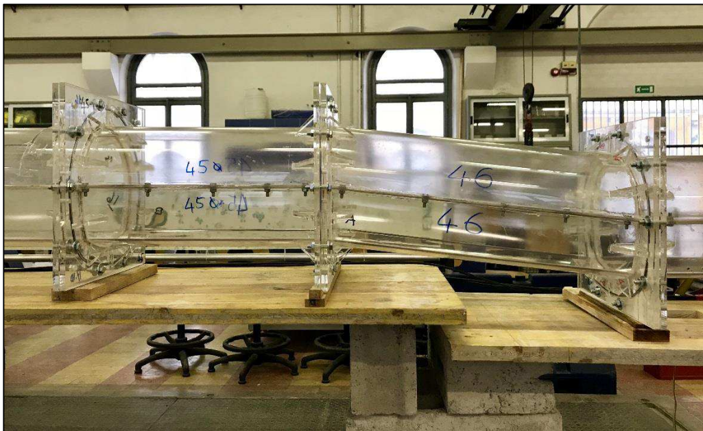
Figura 1 – Scivolo con pendenza 12% al termine del tratto rettilineo principale
