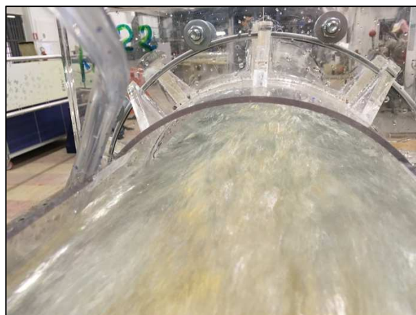
Figura 103. (sx) Sezione 15.06 (termine tratto rettilineo principale) con livelli misurati in destra e in sinistra per livello di massimo invaso e Q=67 l/s (apertura paratoie 13 cm). (dx) vista della corrente in corrispondenza dell'apertura in calotta al termine del tratto rettilineo, resa possibile dal livello corrispondente al contenuto energetico indotto dalla parzializzazione delle paratoie
