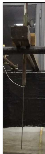
Figura 30. Asta idrometrica utilizzata per le misure lungo il tratto di confluenza
