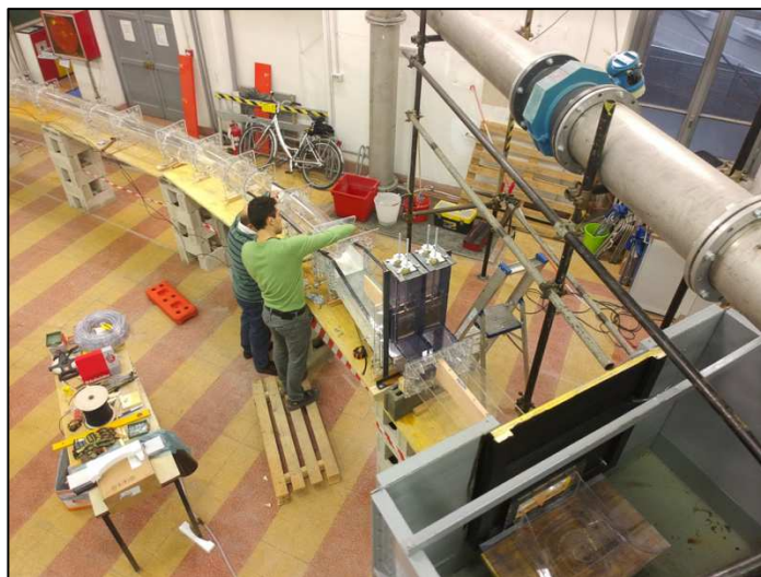
Figura 5. Tratto iniziale del modello: opera di presa, camera delle paratoie e tratto a sezione variabile
