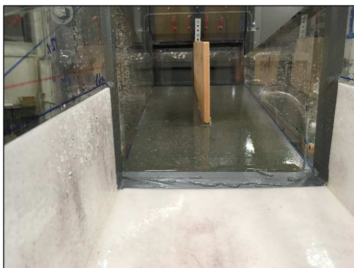
Figura 3. Tratto a geometria variabile a valle delle paratoie con setto centrale. In fondo i fori che simulano gli aerofori
