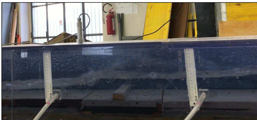
Figura 7 – Effetto di sovrizzo dovuto alla quarta soglia trasversale e conseguente risalto idraulico localizzato tra la sezione 30 e la prima soglia trasversale per Q galleria=22 l/s e Q Chiese=45 l/s (prova 4)
