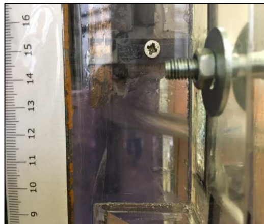
Figura 9. Manufatto di presa dal lago (sx) e particolare della paratoia con luce parzializzata (dx)
