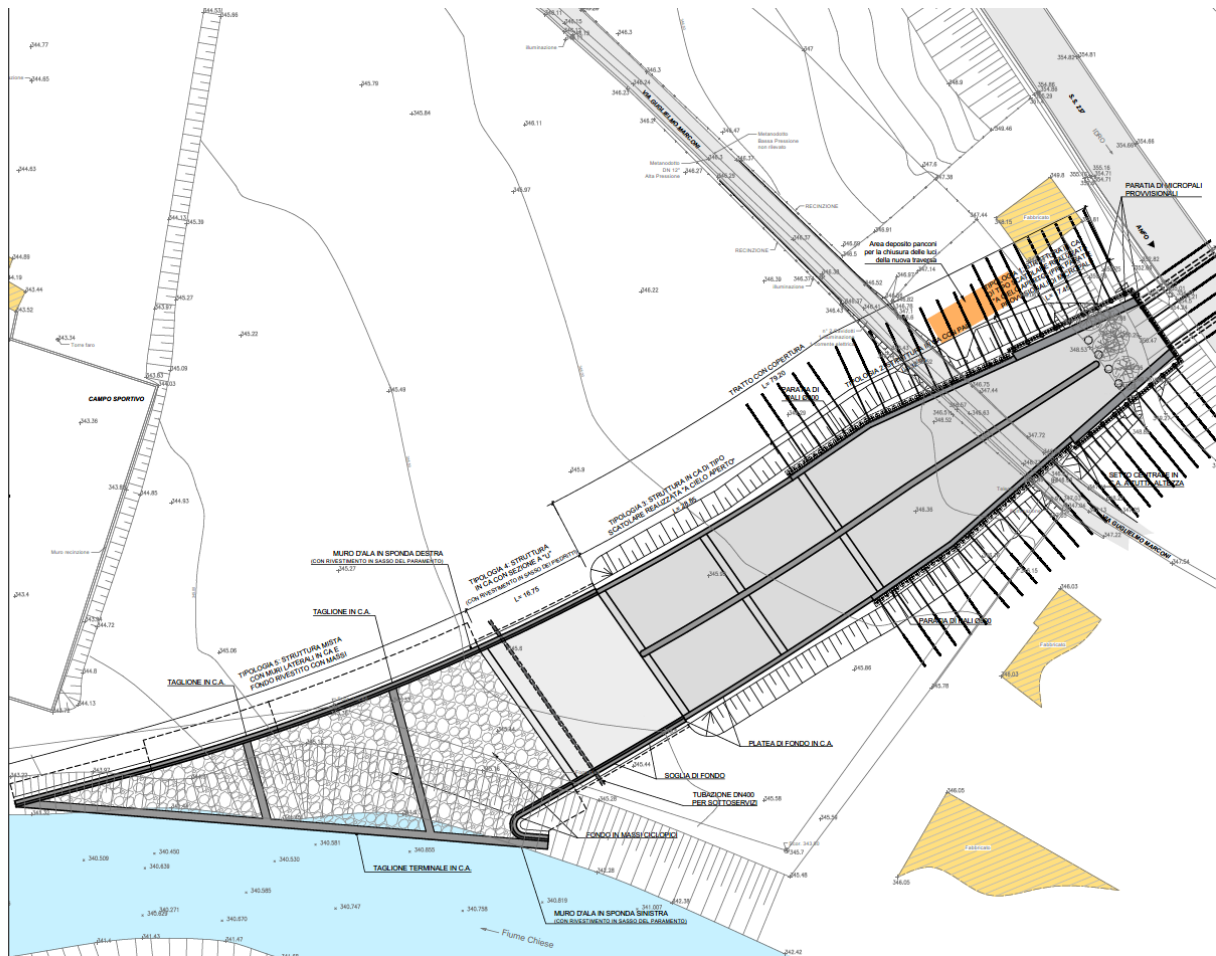
Figura 22. Planimetria manufatto di restituzione
