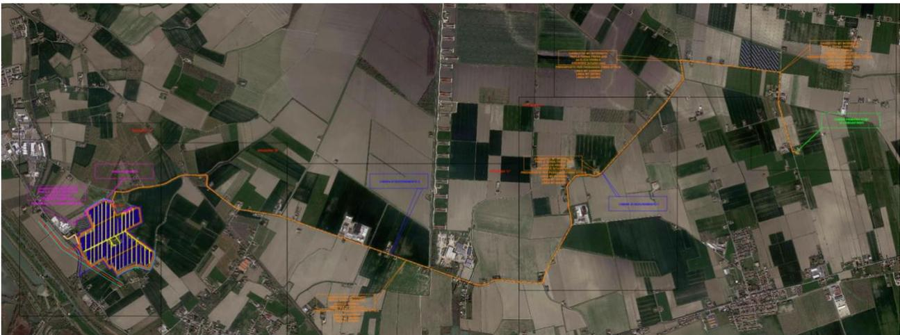
Figura 3. Individuazione percorso cavidotti MT e punti di connessione alle infrastrutture di rete esistenti
